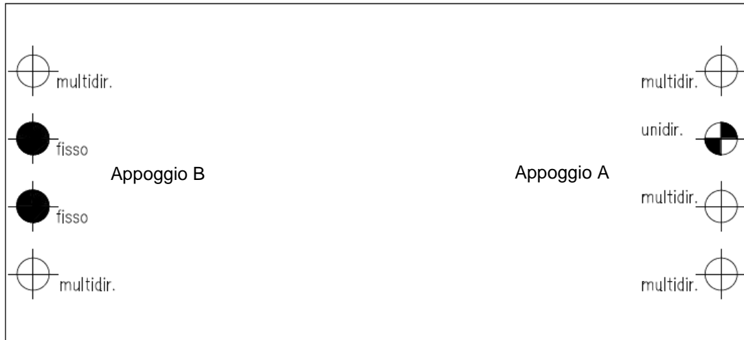
Figura 6.1 Schema degli appoggi degli impalcati
