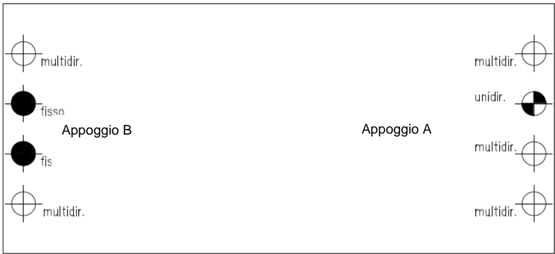
Figura 6.1 Schema degli appoggi degli impalcati
