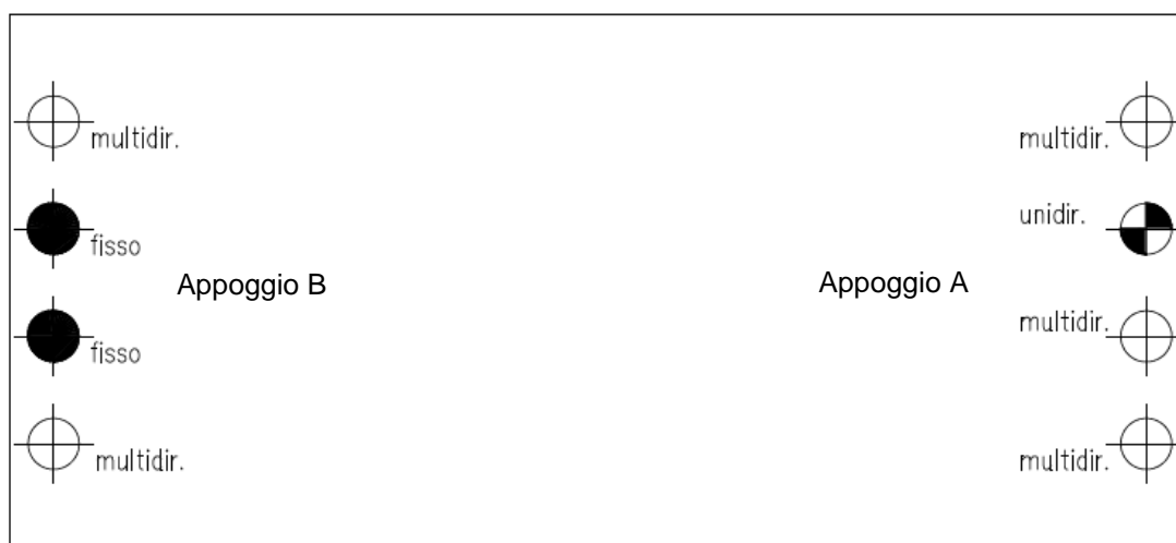
Figura 6.1 Schema degli appoggi degli impalcati
