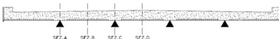
Fig. 48 – Sezioni di verifica
