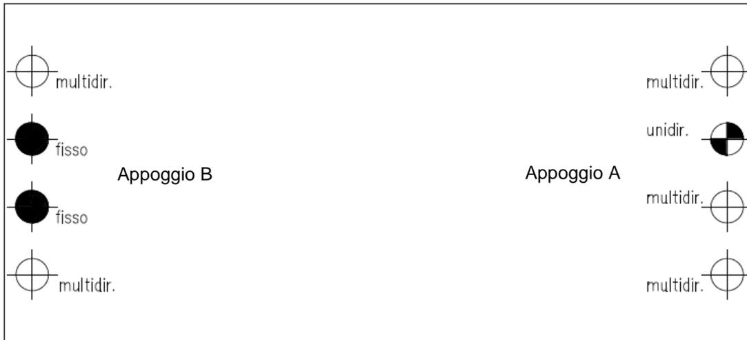
**Figura 6.2 Schema degli appoggi degli impalcati**
