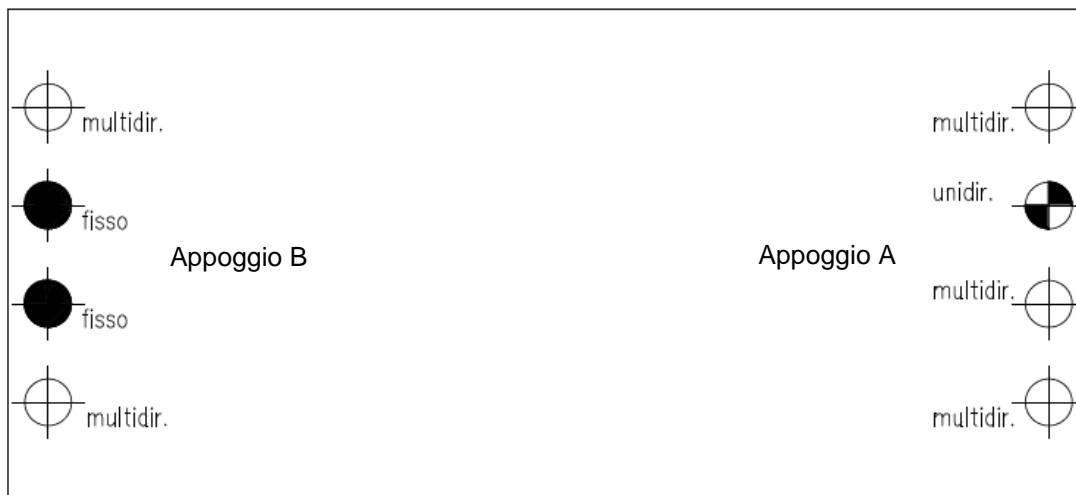
Figura 6.1 Schema degli appoggi degli impalcati
