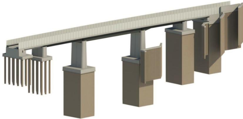
• **Figura 3-7. Viadotto VI02: vista tridimensionale modello BIM - vista da Nord**
