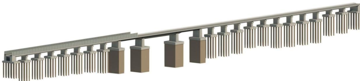
• **Figura 3-3. Viadotto VI01: vista tridimensionale modello BIM**
