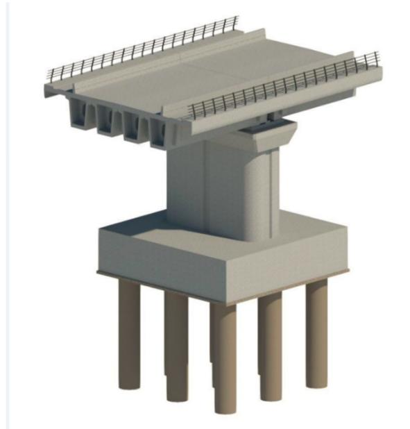
**Figura 3-1. Sezione tipica viadotti impalcati viadotti realizzati con travi a csoncino in in c.a.p.**
