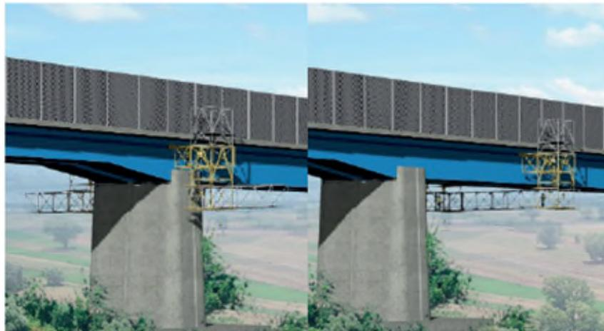
Figura 5.3. Schema funzionamento apertura/chiusura carrello in corrispondenza pile
