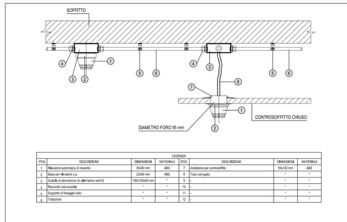
**MODALITÀ DI INSTALLAZIONE A PARETE DI RILEVATORE ANTINCENDIO E RIPETITORE OTTICO**
