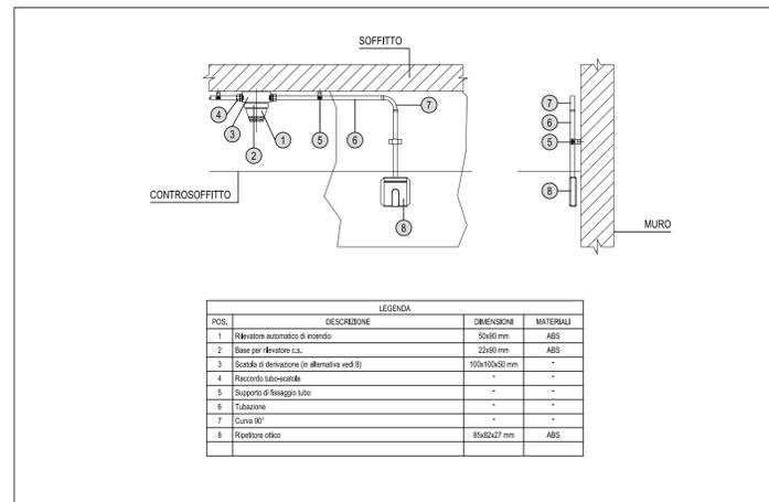
**MODALITÀ DI INSTALLAZIONE DI RILEVATORE ANTINCENDIO IN CONDOTTA**
