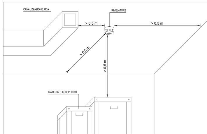
**MODALITÀ DI INSTALLAZIONE SENSORE ANTINCENDIO A SOFFITTO**
