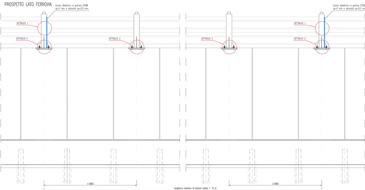
Sezionamento elettrico da adottare per le B.A. fuori dalla zona di rispetto TE (§1.5.4.4.7.1 art.5 doc. RFI DTC SI AG MA IFS 001 A 30-12-2016)
