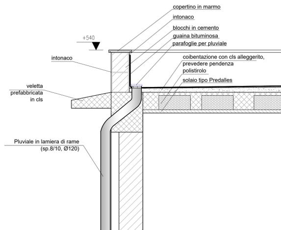
3 PARTICOLARE PLUVIALE A TERRA - Scala 1:20
