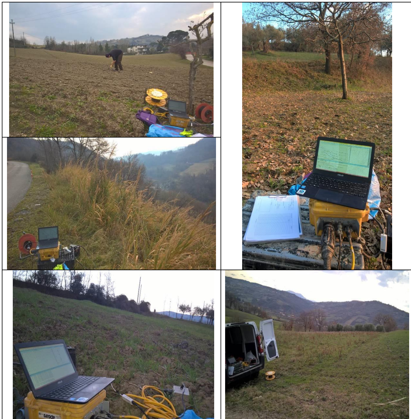
Figura 5.1 – fasi di acquisizione dati geofisici - stese sismiche
