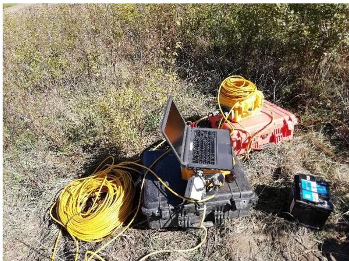
*Strumentazione sismica da superficie*
