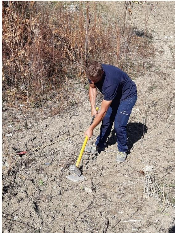
***Energizzazione sismica superficie***
