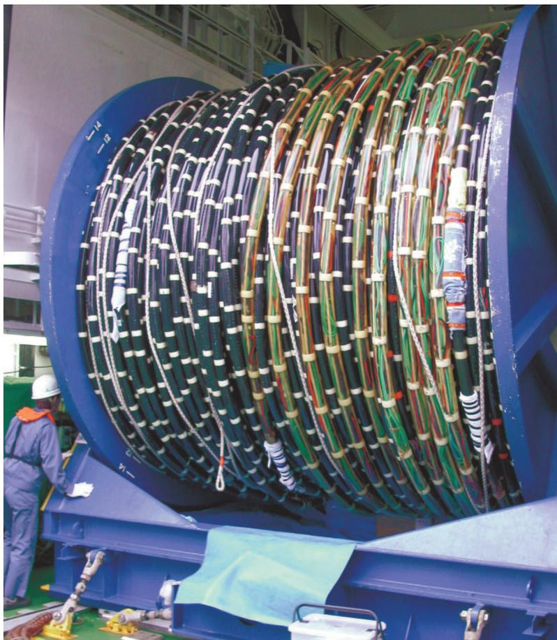
*Figura 2.6- Cavo per acquisizione sismica*
