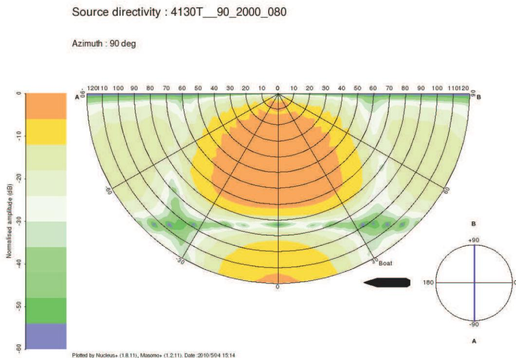
Figura 2.14 - Direzionalità dell'impulso acustico dell' array di air-gun.,
