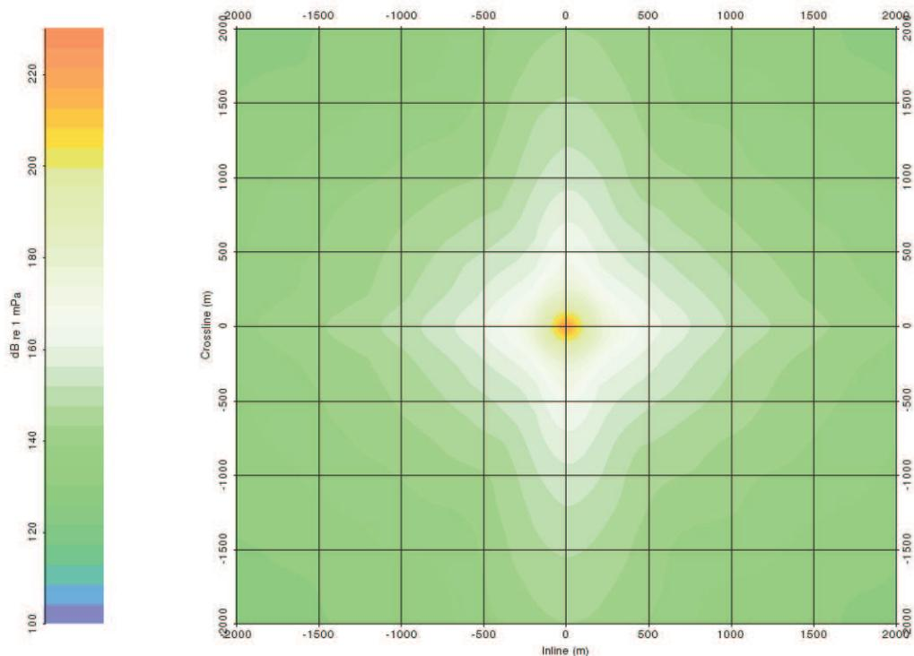
Figura 2.15– Livelli attesi di SPL (Sound Pressure Level) del segnale acustico generato dall’ array di airgun di progetto – Area di indagine 2km da sorgente
