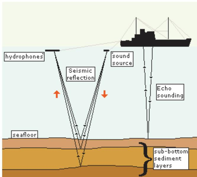
Figura 2.5 - Schema di prospezione geofisica con Air-gun
