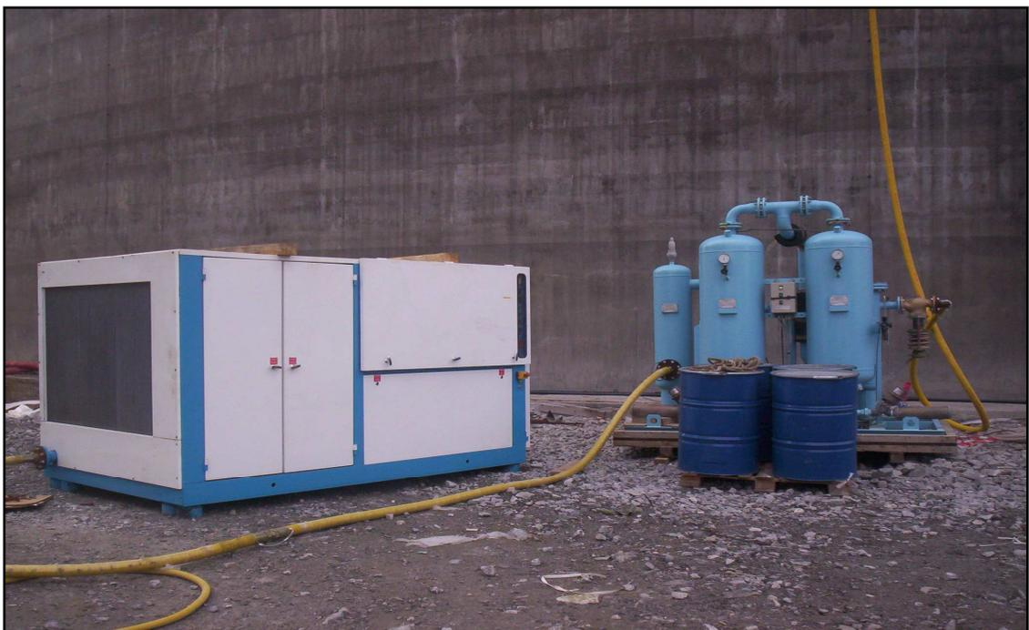
**Asciugatura dei serbatoi con macchine di essiccazione**
