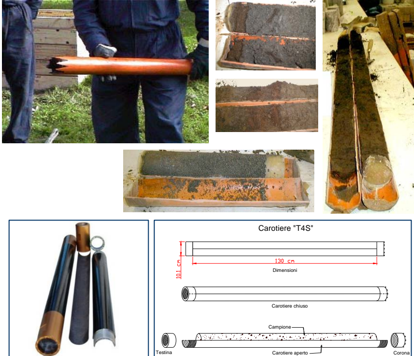
Campionamento di sabbie e limi in falda e a mare mediante fustelle dentellate in PVC
