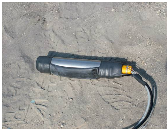
Geofono orizzontale per la rilevazione delle onde P ed S
