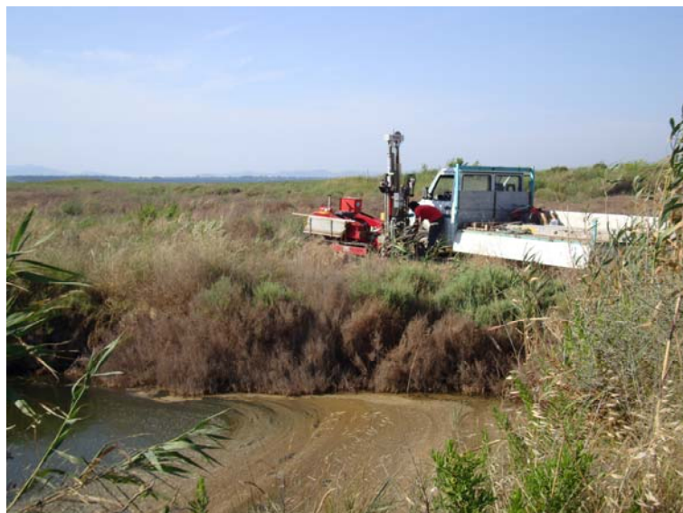
Esecuzione della prova CPTU 07 "Terra rossa"
