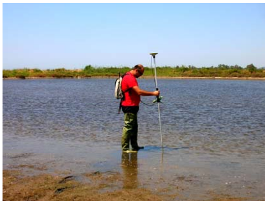
Base GPS su punto quotato IGM di Orbetello (a sinistra) e fase del rilievo piano altimetrico di Pian d'Asca (a destra)
