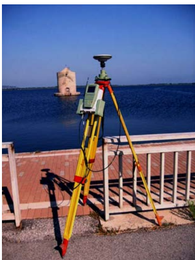
Base GPS su punto quotato IGM di Orbetello (a sinistra) e fase del rilievo piano altimetrico di Pian d'Asca (a destra)
