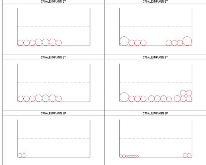
VERIFICA RIEMPIMENTO SEZIONE C-C - SCALA 1:20
