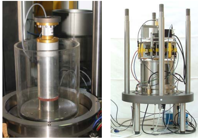
Figura A.1. L'apparecchiatura di taglio torsionale THOR.
