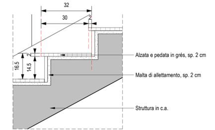
4 Dettaglio gradino scala banchina
