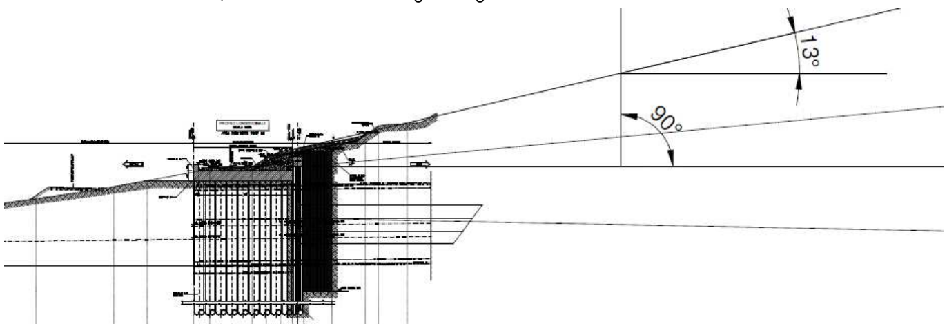
Fig. 18 – Inclinazione media versante di imbocco galleria Grottaminarda – lato Napoli
