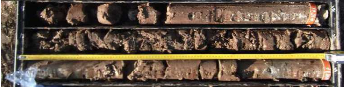
Fig. 4 – Livello geotecnico 2 (Formazione geologica del FYRc ) nel sondaggio C10
