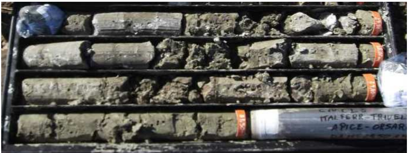
Fig. 5 – Livello geotecnico 3 (Formazione geologica del FYRc ) nel sondaggio C10
