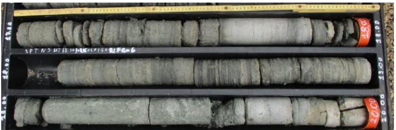
Fig. 6 – Livello geotecnico 4 (Formazione geologica del BNA1b) nel sondaggio SME1
