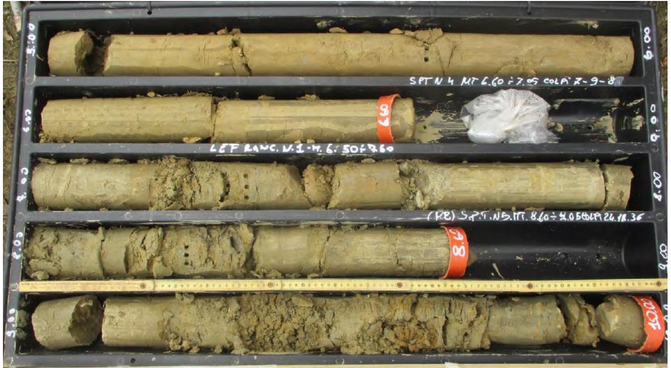
Fig. 3 – Livello geotecnico 1 (Formazione geologica del BNA1b) nel sondaggio SME4
