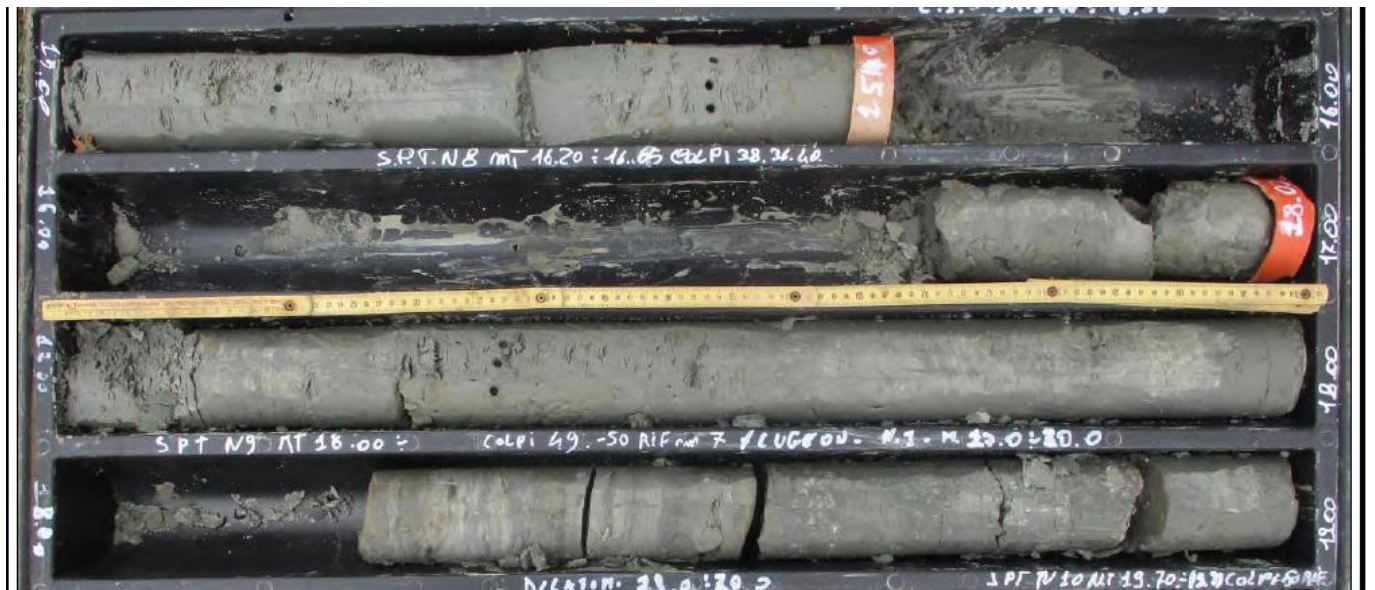
Fig. 4 – Livello geotecnico 2 (Formazione geologica del BNA2) nel sondaggio SME4
