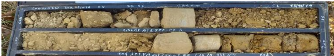
Fig. 3 – Livello geotecnico 1 (Formazione geologica del BNA1b) nel sondaggio RI56
