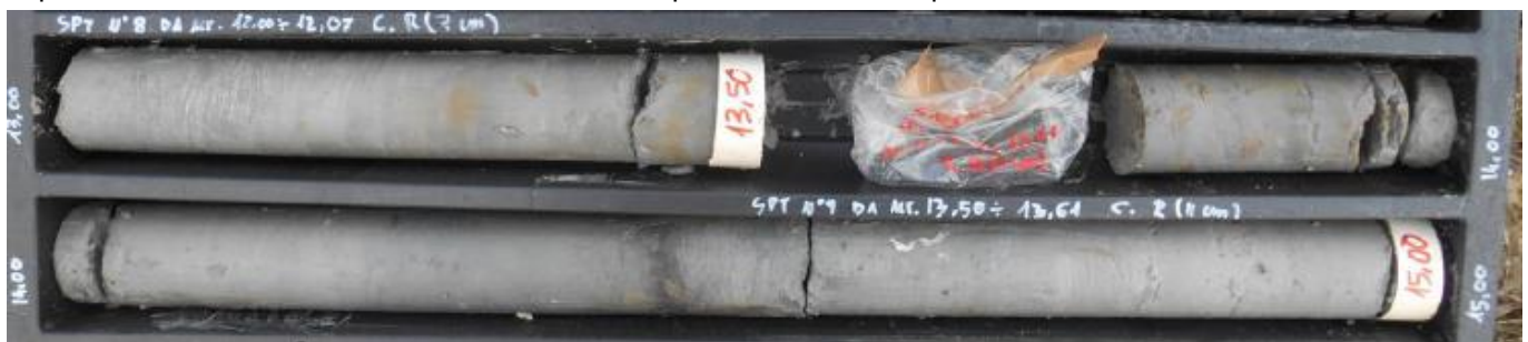
Fig. 5 – Livello geotecnico 3 (Formazione geologica del BNA2) nel sondaggio SME7
