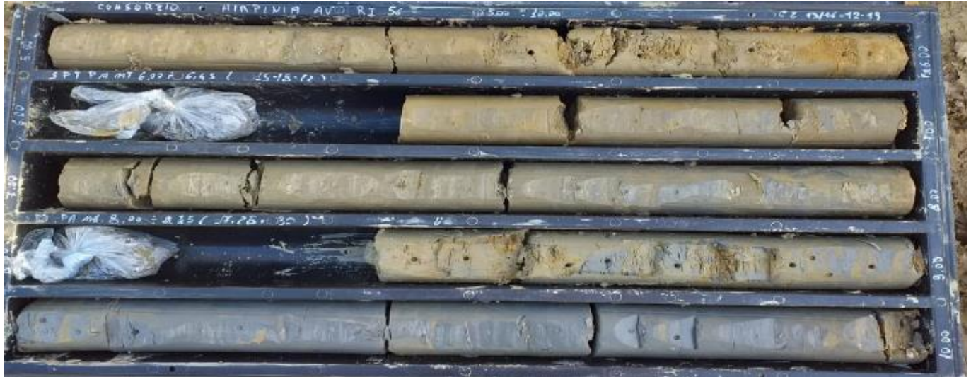
Fig. 4 – Livello geotecnico 2 (Formazione geologica del BNA1b) nel sondaggio RI56
