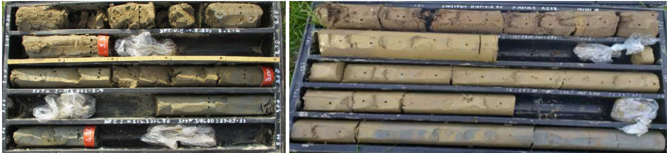
Fig. 3 – Livello geotecnico 1 (depositi franosi della formazione geologica del BNA1b) nel sondaggio SROC2 (sx) e RI58 (dx)
