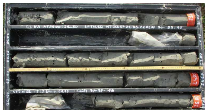
Fig. 5 – Livello geotecnico 3 (formazione geologica del BNA2) nel sondaggio SROC2
