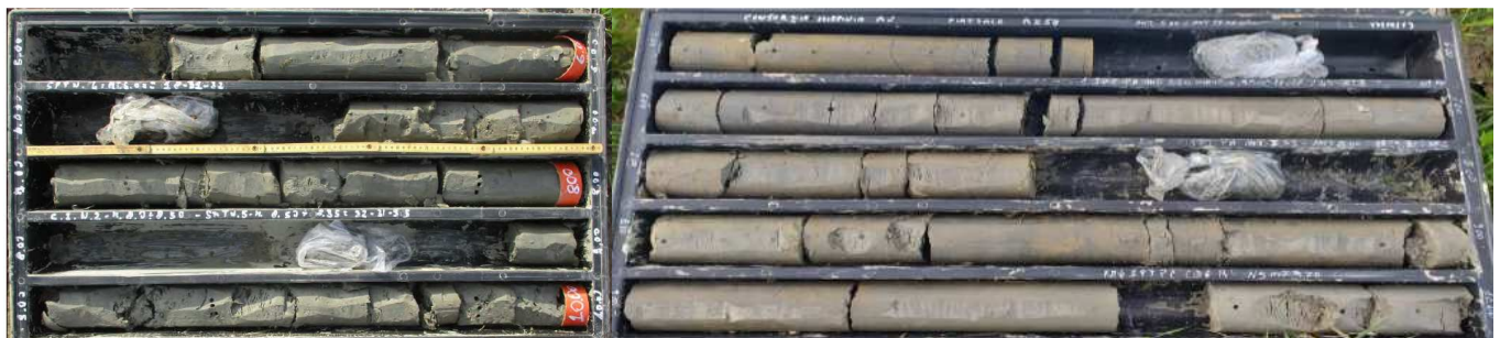
Fig. 4 – Livello geotecnico 2 (formazione geologica del BNA2) nel sondaggio SROC2 (sx) e RI58 (dx)
