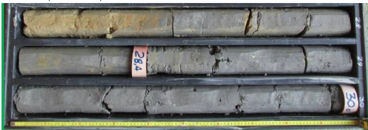
Fig. 4 – Livello geotecnico 4 (Formazione geologica del BNA3) nel sondaggio S23
