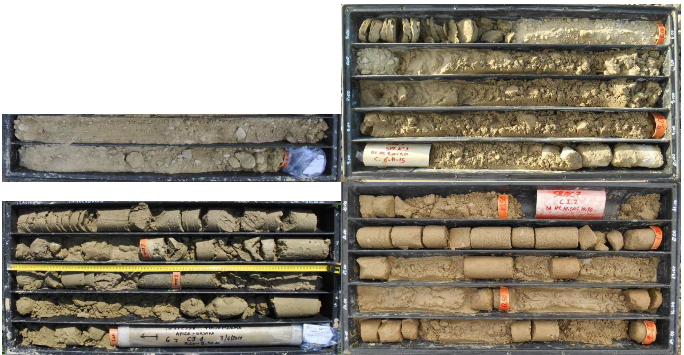
Fig. 3 – Livello geotecnico 2 (formazione geologica del BNA3) nel sondaggio G7 (sx) e SROC7 (dx)
