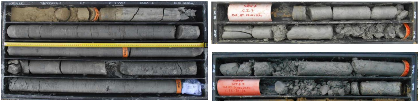
Fig. 4 – Livello geotecnico 3 (formazione geologica del BNA3) nel sondaggio G7 (sx) e SROC7 (dx)
