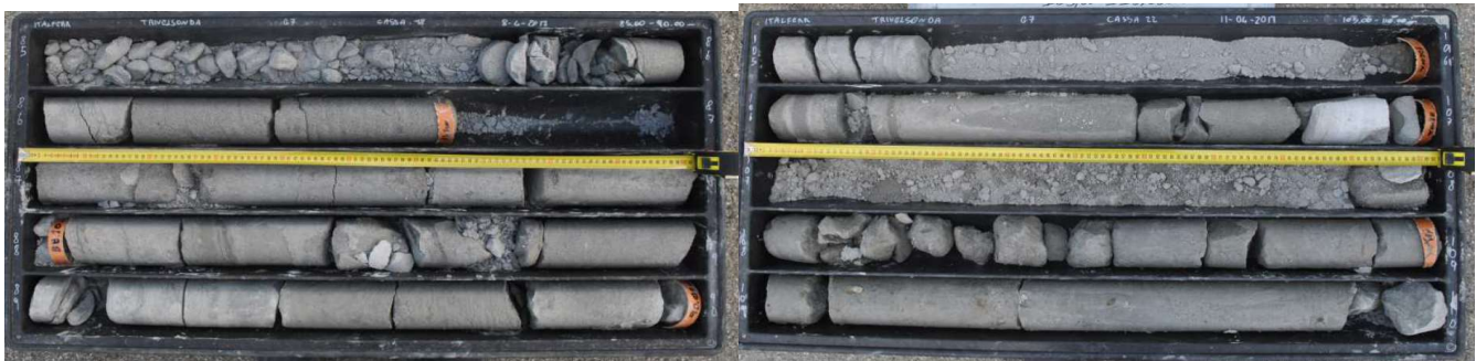
Figura 11-34 – Esempio di famiglie di tipo “3” e “4” per la classificazione geomeccanica dell'ammasso
