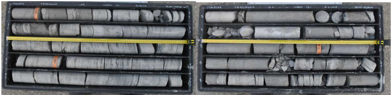
Figura 11-33 – Esempio di famiglie di tipo “1” e “2” per la classificazione geomeccanica dell'ammasso
