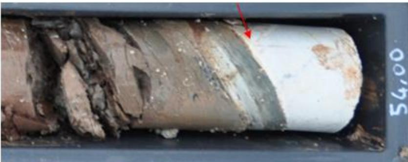
*Figura 1.40. Chiare evidenze di passaggi stratigrafici tra argille e calciluti intercalate alle facies conglomeratiche del F. Rosso (sondaggio SNME07).*
