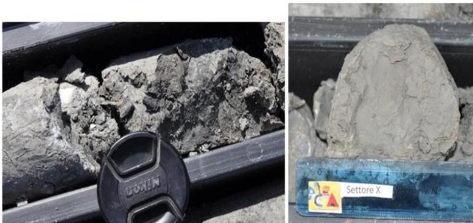
Figura 1.20. Dettagli della facies FYRagms a quota cavo galleria. È possibile osservare l'aspetto caotico delle argille e la loro struttura a scaglie.
