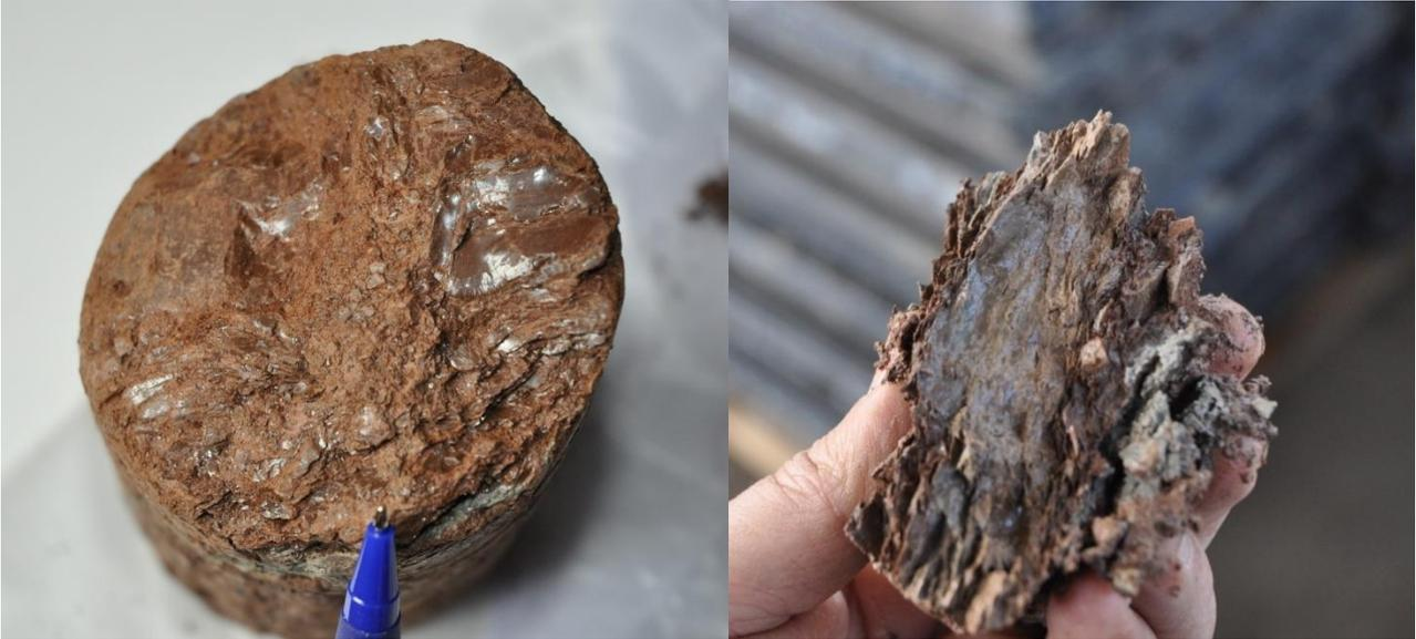
*Figura 1.23. Evidenza di clivaggio e scagliosità alla scala del campione nelle argille FYRavc.*
