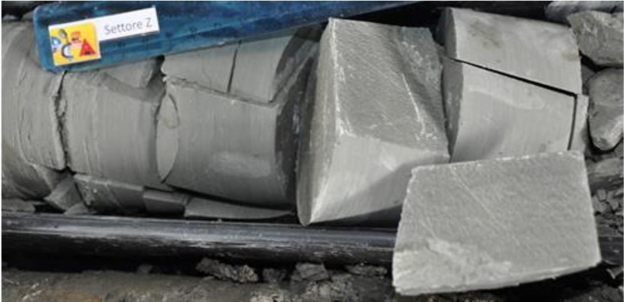
*Figura 1.34. Particolare della facies marnosa (FYRmar) alla progressiva km 4 +350 a quota cavo galleria.*
