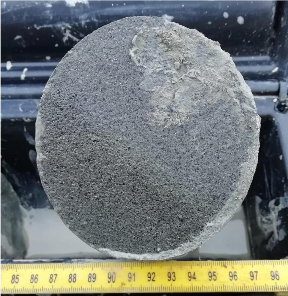
*Figura 1.65. Particolare delle arenarie e delle sabbie di Anzano (ANZ2ar) a quota cavo della galleria.*
