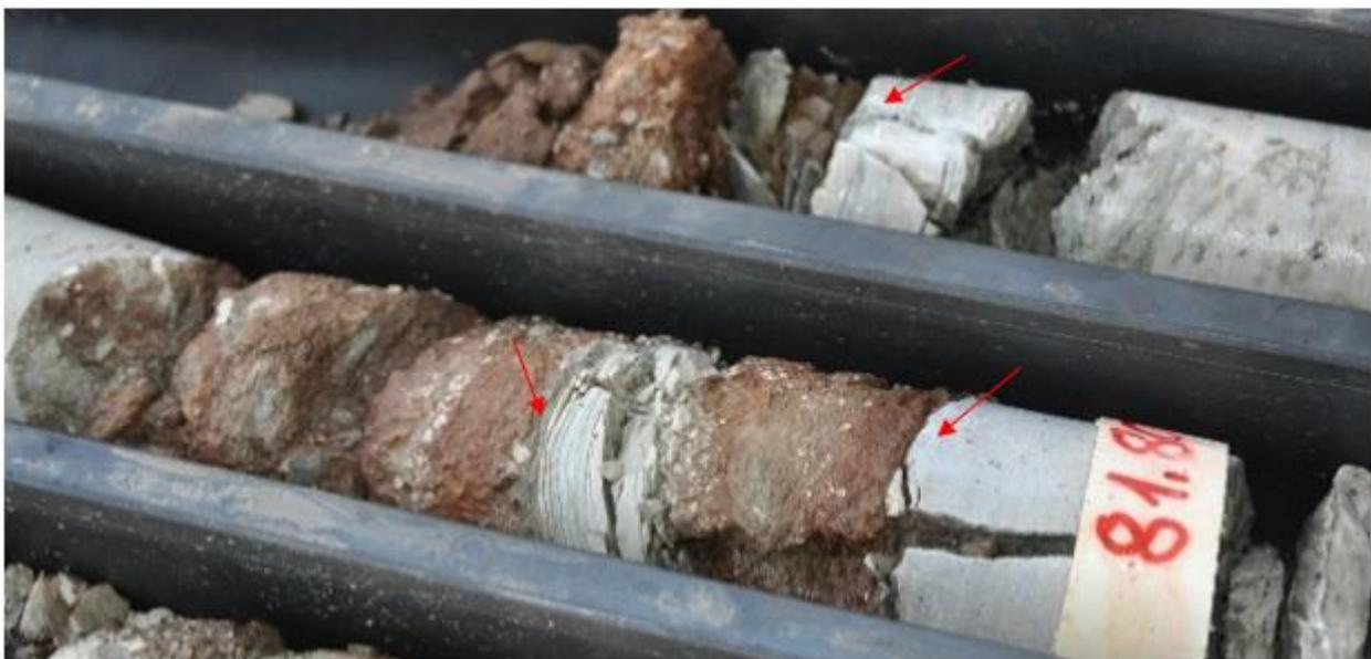
Figura 1.45. Particolare delle alternanze di argille e calcari del Fysch Rosso (FYRac) a quota cavo della galleria alla progressiva km 5 +900. È possibile osservare i bruschi passaggi stratigrafici tra i due litotipi.
