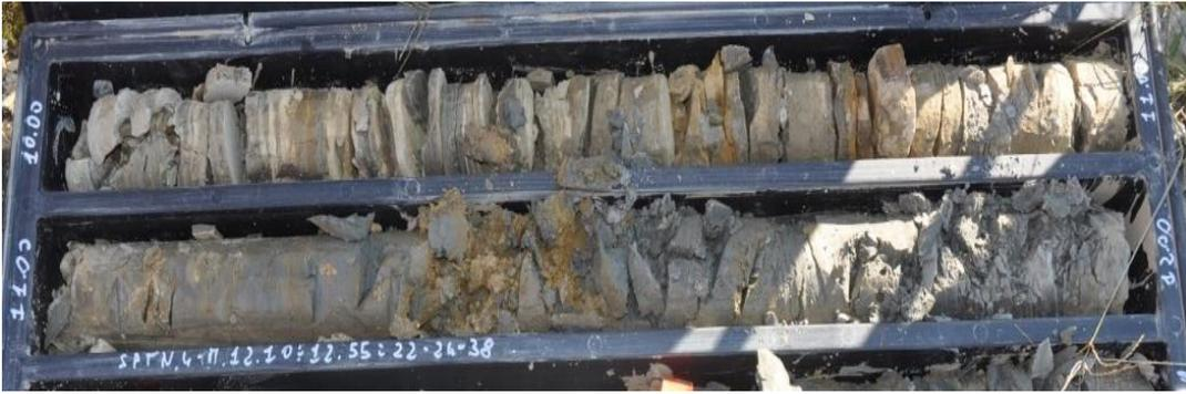
*Figura 1.63. Arenarie, sabbie ed argille di Anzano: aspetto alla perforazione.*
