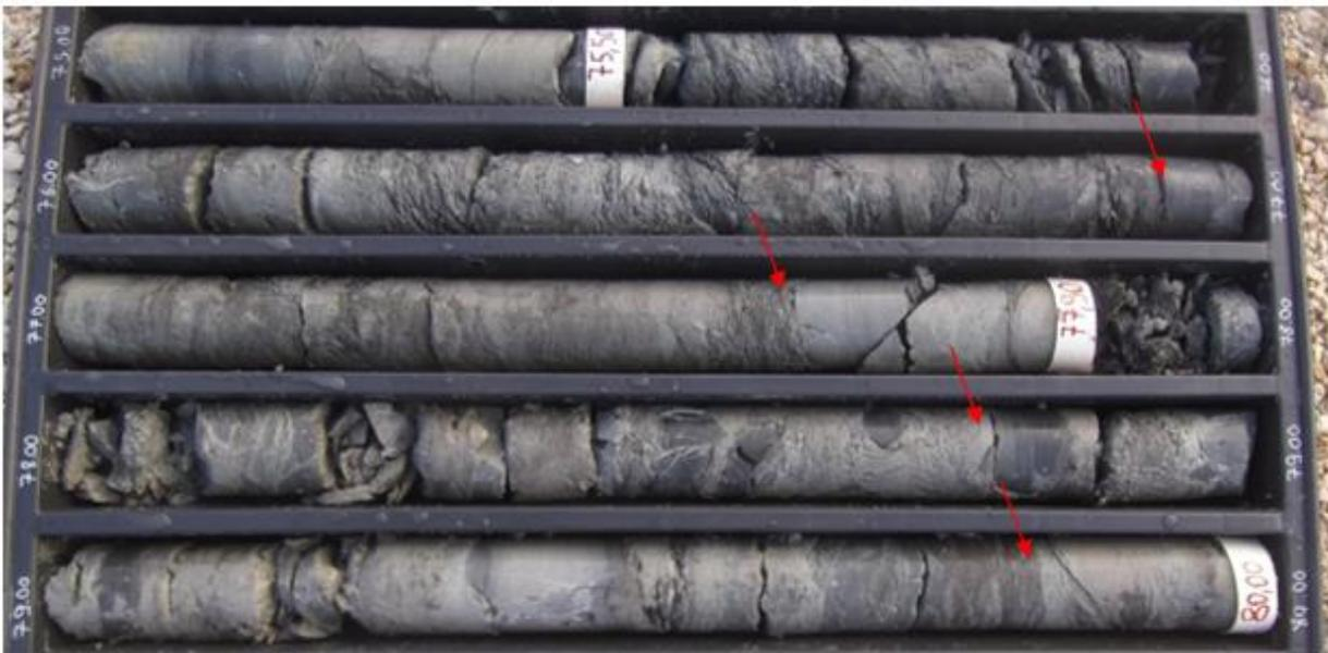
Figura 1.17. Le argille grigie marnoso-scagliose passano in profondità a facies più francamente marnose e conglomeratiche nella quali comunque è possibile riconoscere le stratificazioni (sondaggio SN03).
