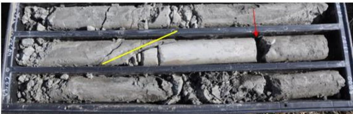
Figura 1.13. Stratificazione nel sondaggio SN01. Da notare che gli intervalli lapidei hanno spessore di 10/20 cm e si ripetono ad intervalli regolari (circa ogni metro). In giallo piani di taglio ad alto angolo.
