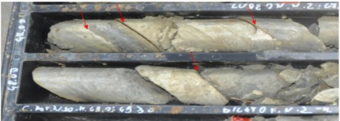
Figura 1.32. Chiare evidenze di stratificazione marcate da differenze granulometriche e cromatiche nel sondaggio SN GR 06.
