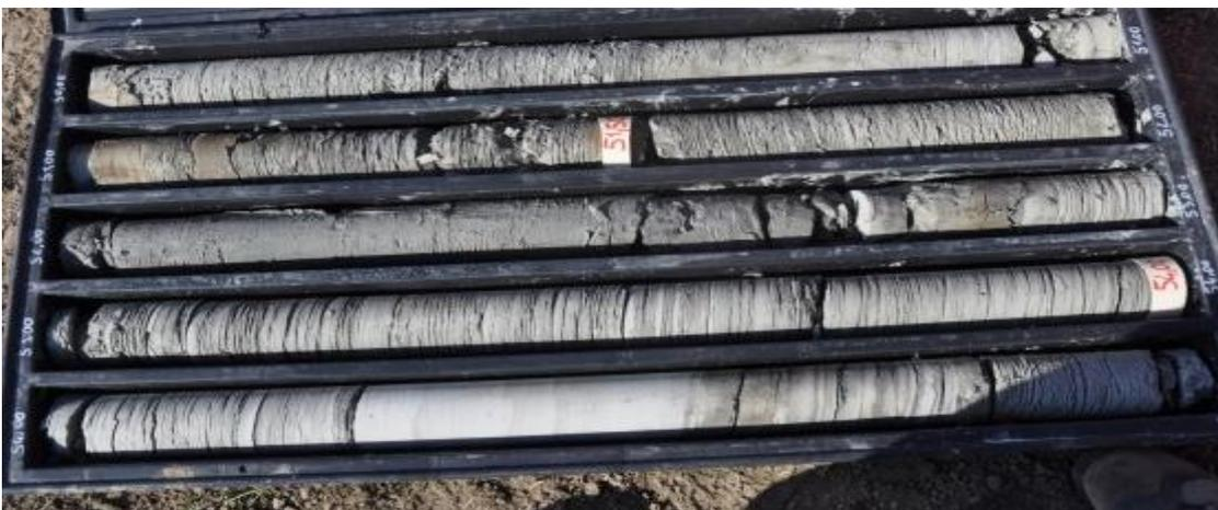
*Figura 1.70. Evidenze nel carotaggio della fitta stratificazione e passaggi stratigrafici a facies francamente marnose nella formazione della Baronia (BNA2ag).*
