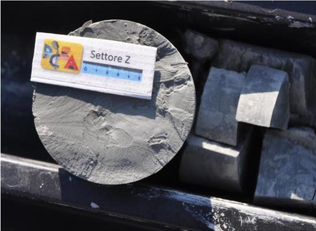
*Figura 1.71. Dettaglio della facies più francamente marnosa alla quota cavo della galleria Melito alla progressiva Km 7 +350.*
