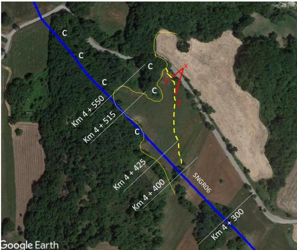
*Figura 1.61. Il settore in cui sono state effettuate le perforazioni orizzontali teleguidate. La lettera "c" indica affioramenti di calcari.*
