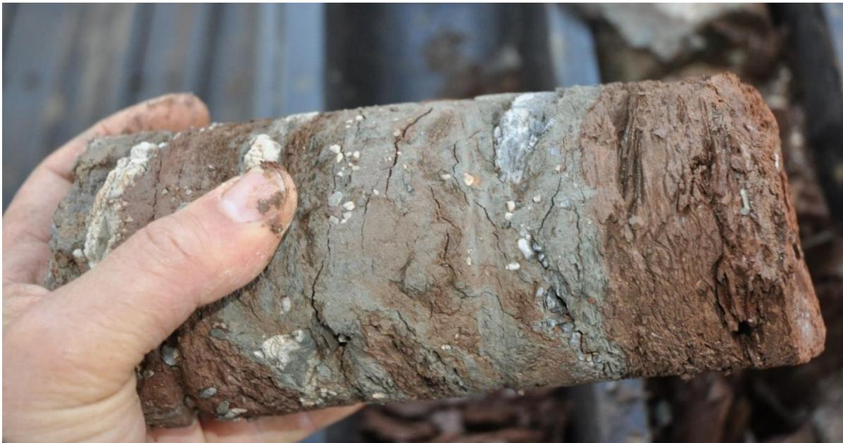
*Figura 1.24. Le fitte alternanze di colorazione (verdi e rosse) delle argille FYRavc.*
