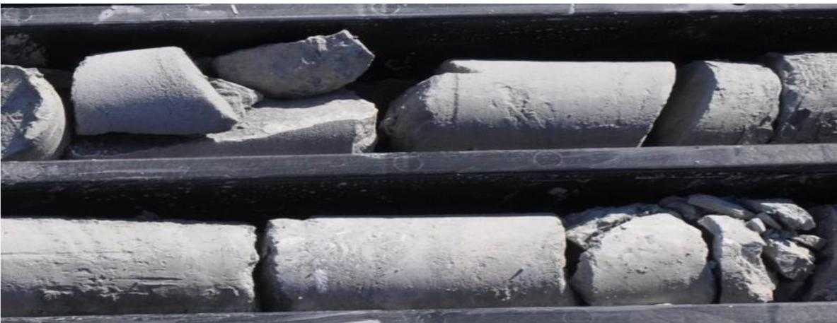
*Figura 1.68. Dettaglio della facies ANZ2 marnoso-argillosa a quota cavo galleria alla progressiva km 3 +205 (sondaggio SN GR 02).*
