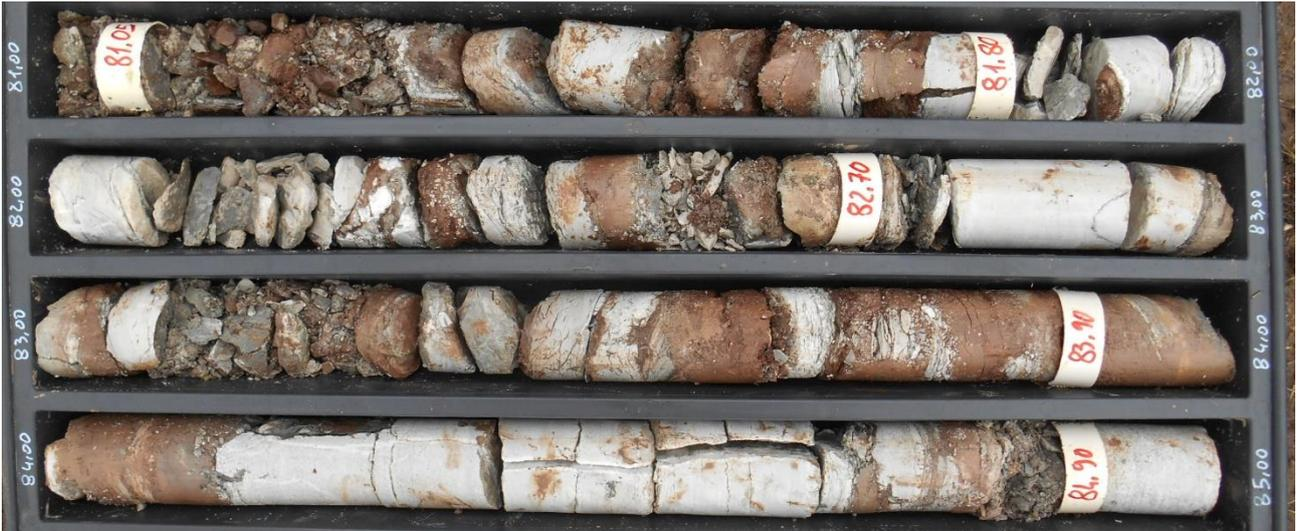
Figura 1.43. Alternanze di calcilutiti ed argille nella facies FYRac (sondaggio SNME07) in prossimità del cavo galleria.
