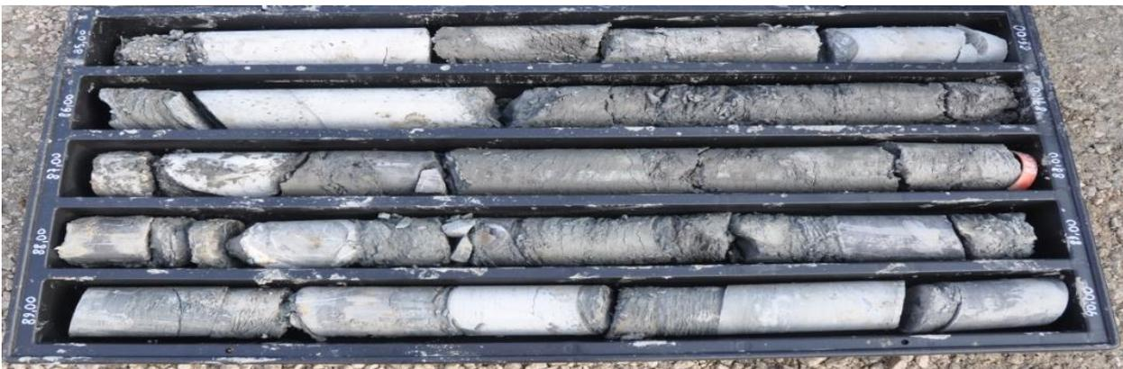
*Figura 1.30. Riduzione della frazione pelitica ed aumento di quella calcarea nella parte più profonda del membro FYRagms.*
