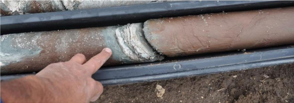
Figura 1.25. Variazioni cromatiche nelle argille FYRavc ed intercalazione di calcilutiti biancastre.
