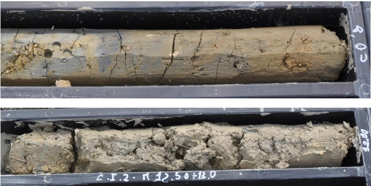
*Figura 1.72. Tipici aspetti delle argille dei cumuli di frana (sondaggio SN01 nella frana della galleria Grottaminarda).*
