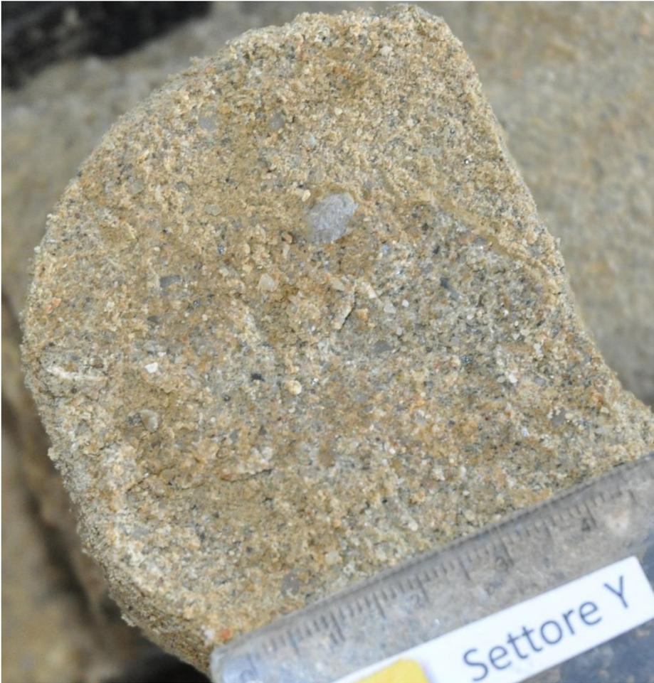
*Figura 1.37. Foto di dettaglio delle arenarie del Fysch Rosso (FYRar) alla quota del cavo della galleria alle progressive km 4 +400 e 6 +540. È possibile osservare la presenza di numerosi minerali silicatici (sialici e femici) sub arrotondati.*
