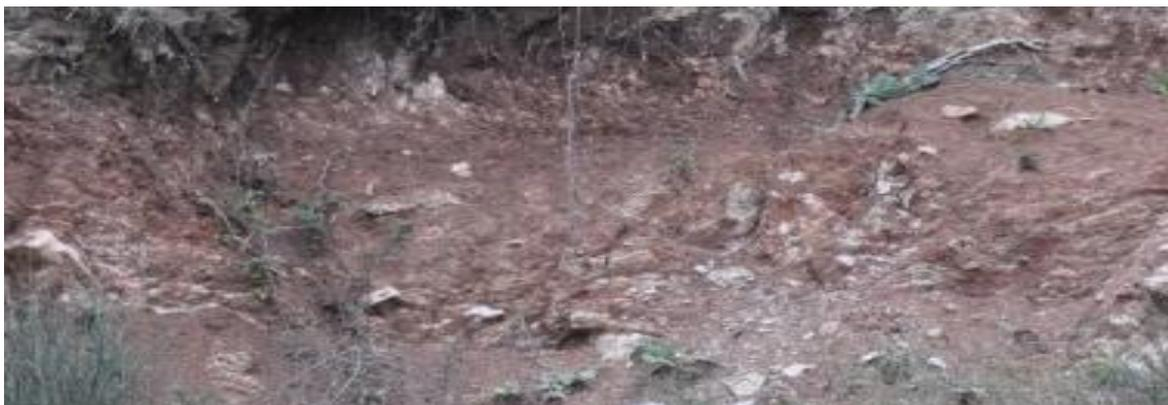
*Figura 1.22. Affioramento della facies argillosa policroma del Flysch Rosso (FYRavc) nei pressi del sondaggio SNME07 della galleria Melito.*
