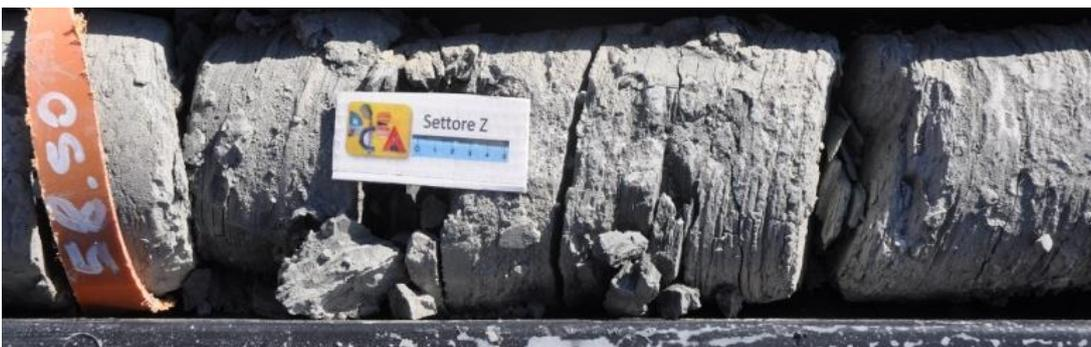
*Figura 1.66. Particolare delle arenarie e sabbie di Anzano (ANZ2ag) a quota cavo della galleria nel settore orientale (lato Bari) della galleria Gsottaminarda.*
