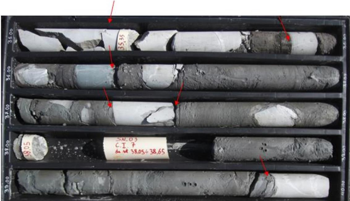
Figura 1.16. Stratificazione nel sondaggio SN03. Da notare che gli intervalli lapidei hanno spessore di 10/20 cm e si ripetono con intervalli regolari (circa ogni metro).
