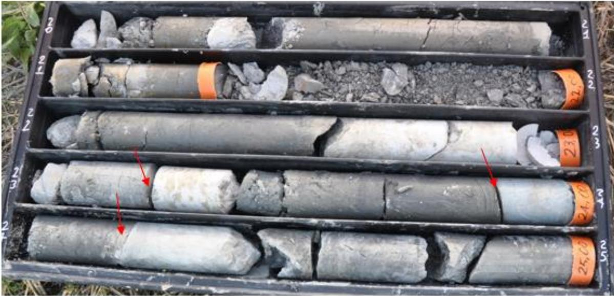
*Figura 1.18. Stratificazione del sondaggio CH2. Da notare che gli intervalli lapidei hanno spessore di 10/20 cm e si ripetono con intervalli regolari (circa ogni metro).*
