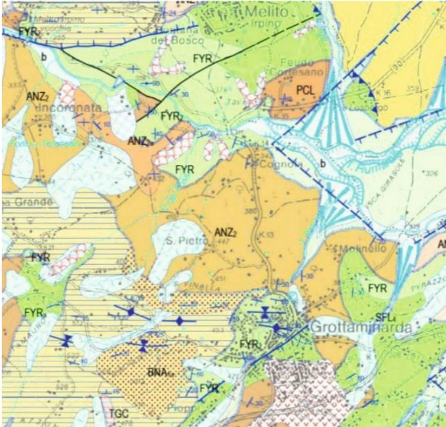
Figura 1.8. Stralcio del foglio geologico CARG del settore interessato dalle gallerie Grottaminarda e Melito.
