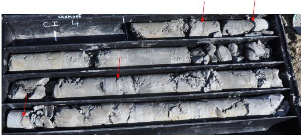
Figura 1.12. Stratificazione nel sondaggio SNGR05. Da notare che gli intervalli lapidei hanno spessore di 5/10 cm e che si ripetono con intervalli regolari (circa ogni metro).
