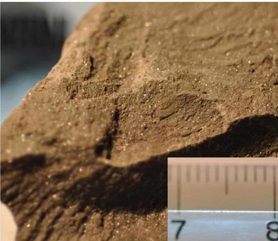
*Figura 1.74. Le argille marnoso arenacee della Formazione di Anzano. Sono ben evidenti i cristalli di fillosilicati e la fratturazione concoide.*
