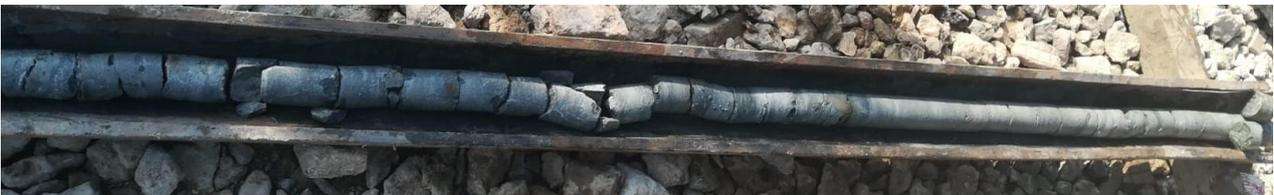
*Figura 1.35. La facies arenacea lapidea del Flysch Rosso (FYRar) poco fratturata, ben stratificata e con alti valori di RQD (sondaggio SN GR 04 e SNME05).*
