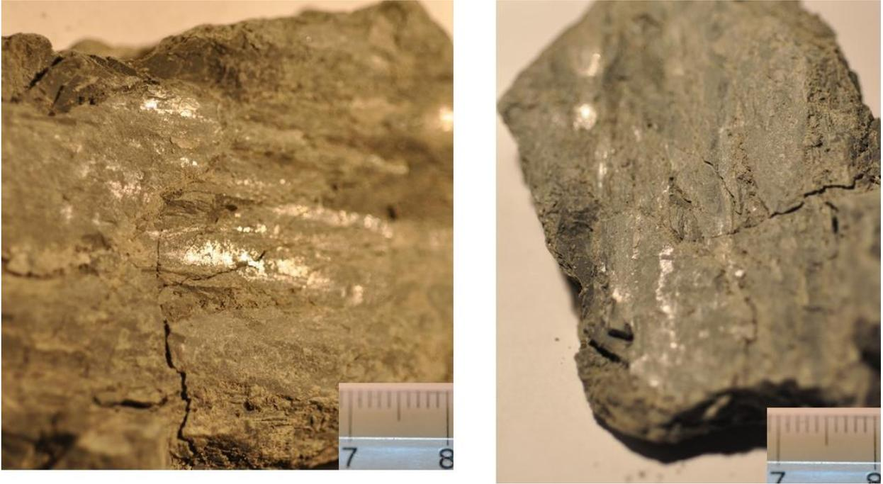
*Figura 1.75. Le argille marnoso-scagliose (FYRags) del F. Rosso. Sono evidenti le ondulazioni da clivaggio e la scagliosità evidenziata dalle superfici traslucide.*
