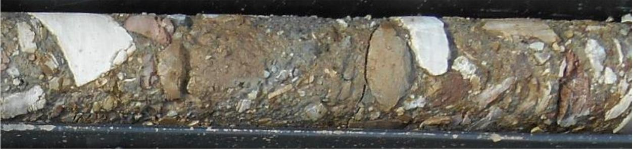
*Figura 1.41. Particolare della facies conglomeratica “caotica” del Fysch rosso (FYRcg) a quota cavo della galleria alla progressiva Km 6 +570. È possibile osservare la presenza di clasti poligenici, smussati, immersi in una matrice argillosa.*
