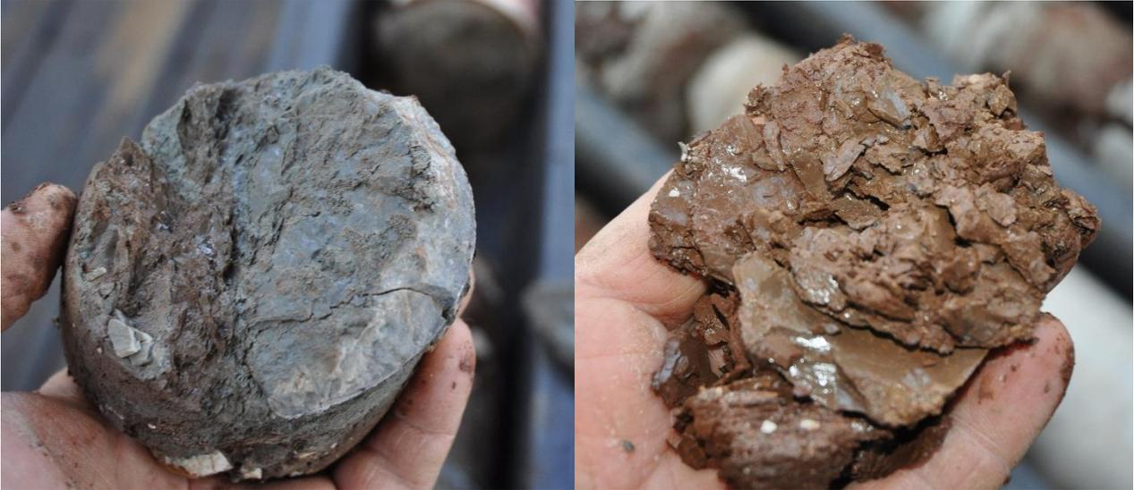
*Figura 1.27. Dettagli della facies FYRavc a quota cavo galleria. È evidente l'aspetto caotico e scaglioso delle argille (sondaggio SNME03).*
