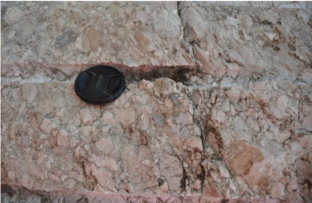
*Figura 1.58. Particolare delle calciruditi lapidee (Brecciato Irpino) che si incontreranno al cavo della galleria nei tratti da scavare in calcare (FYR2C).*
