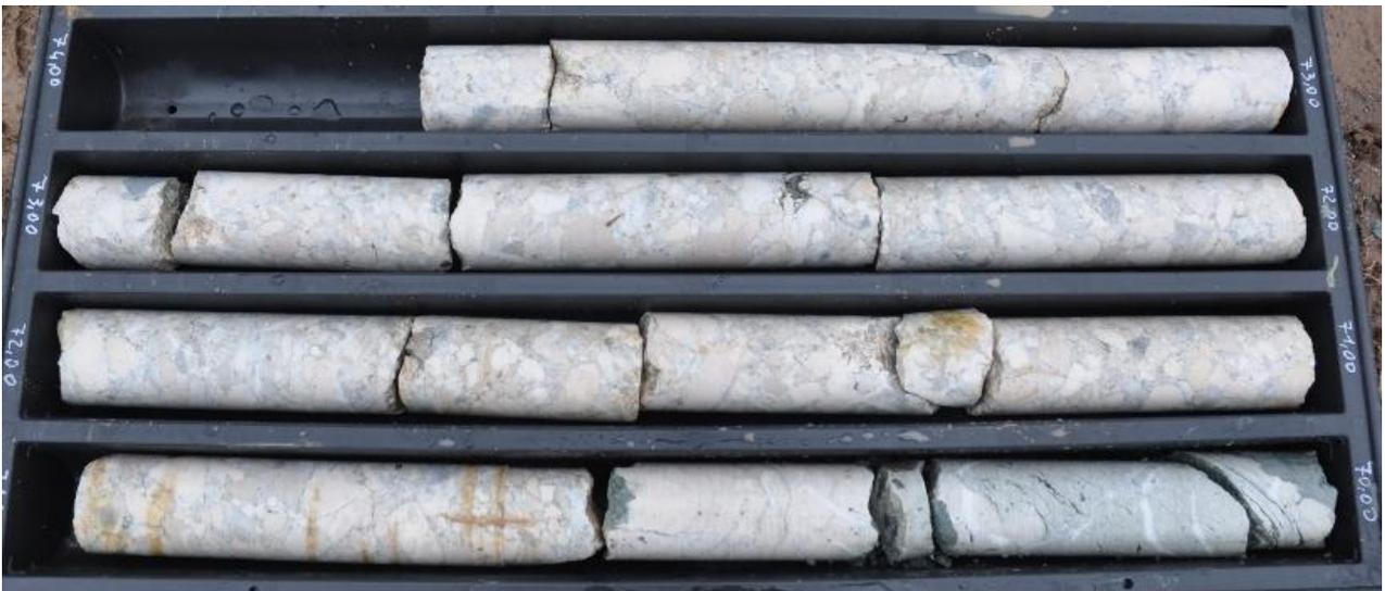
*Figura 1.55. Facies prevalentemente calcarea FYR2C come si presenta al carotaggio con alti valori di RQD (SNME07).*
