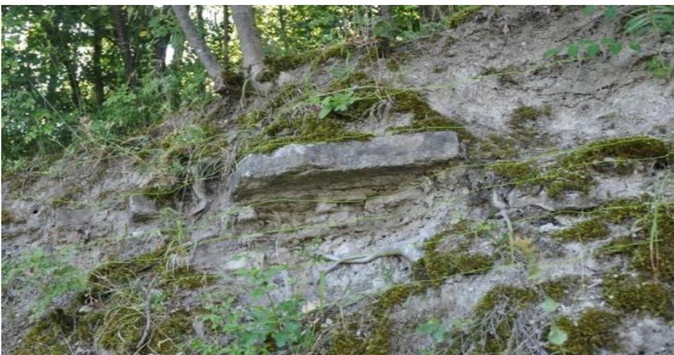
*Figura 1.62. Tipico affioramento delle arenarie pelitiche della formazione di Anzano ANZ2ar lungo la galleria Grottaminarda.*
