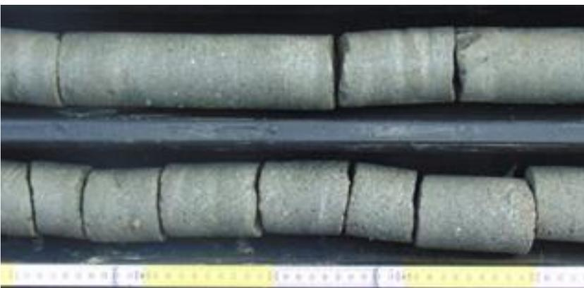
*Figura 1.36. Dettaglio delle arenarie grigie nel sondaggio SNME07.*
