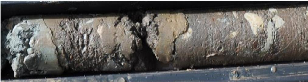
*Figura 1.39. Breccie e conglomerati sindeposizionali in abbondante matrice rossa e verde (Flysch rosso). Sondaggio SN ME 01.*
