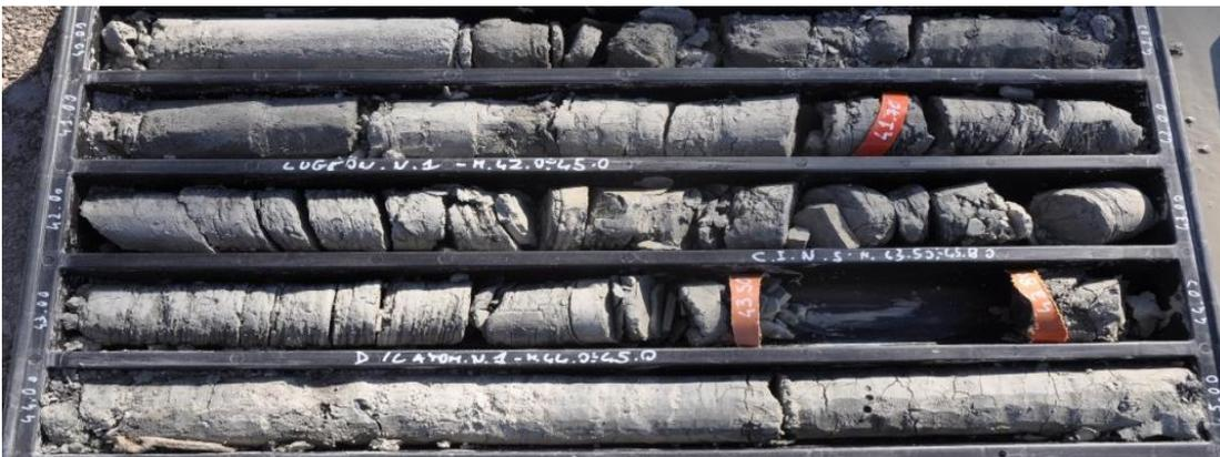
*Figura 1.64. Argille grigie e sabbie di Anzano (ANZ2ag). È possibile osservare la fitta stratificazione alla scala centimetrica.*
