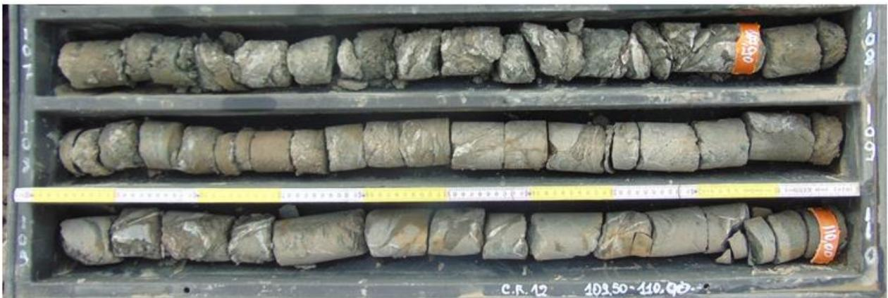
Figura 1.33. Successioni marnose poco deformate probabilmente attribuibili alla formazione di Vallone Ponticello.
