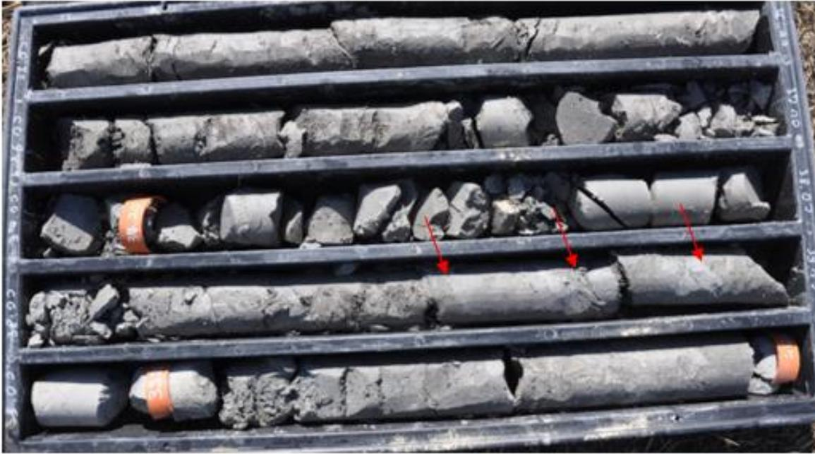
Figura 1.19. Stratificazione nel sondaggio CH7. Da notare la presenza di sottili strati lapidei.
