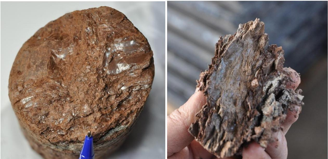
*Figura 1.76. Le argille policrome (FYRavc). È ben evidente la scagliosità e la presenza di superfici traslucide lungo i piani di intensa deformazione (stress tettonico).*
