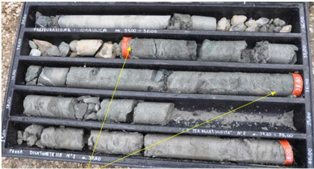
Figura 1.15. Stratificazione nel sondaggio SN02. Da notare un locale strato marnoso-conglomeratico "caotico" da collegare a canalizzazioni di apporti grossolani all'interno del bacino di sedimentazione.
