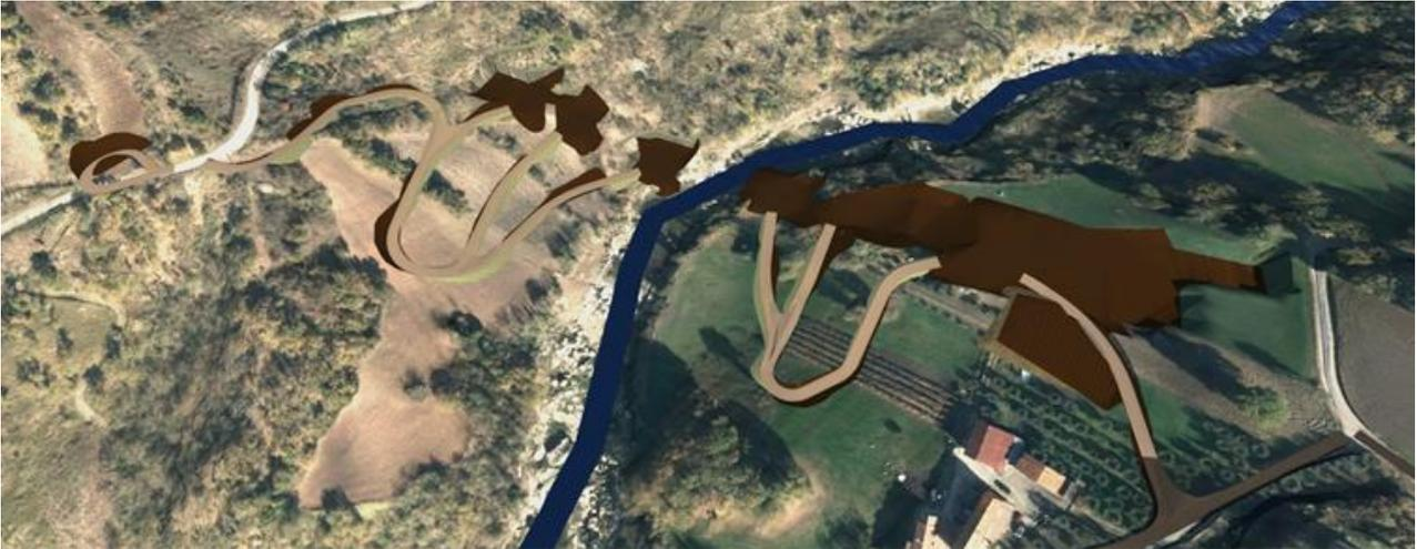
Figura 4-5. Piste di cantiere e interferenze con le viabilità esistenti in corrispondenza del Viadotto VI02
