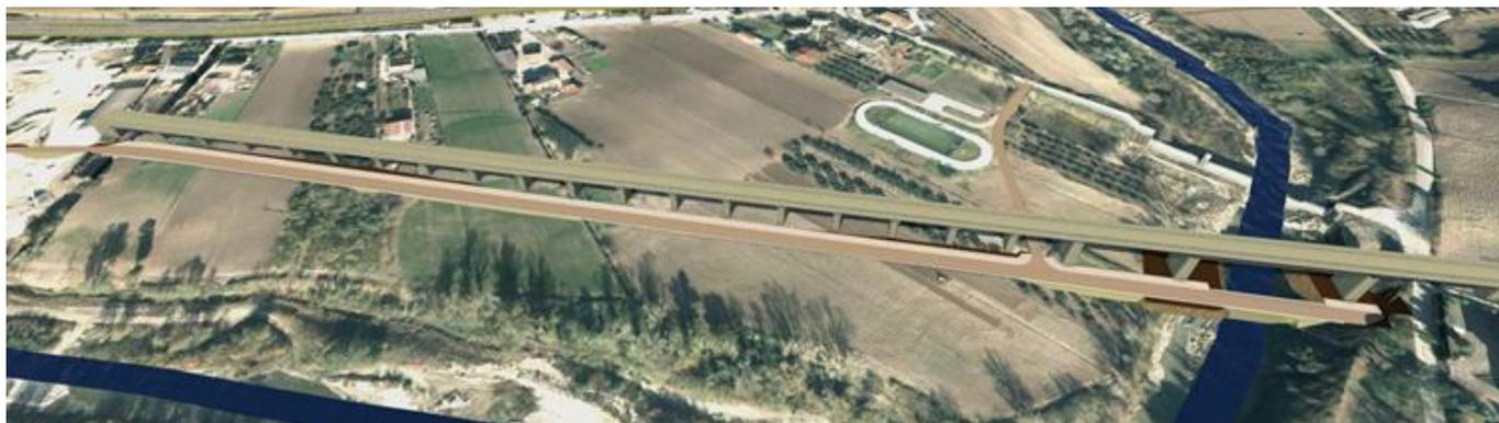
Figura 4-9. Configurazione della pista di cantiere del viadotto VI04 e posizione guado in alveo
