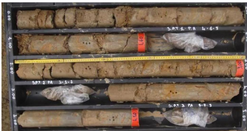
Fig. 1 – Livello geotecnico 1 (Formazione geologica dell' ANZ2ar) nel sondaggio SGR1
