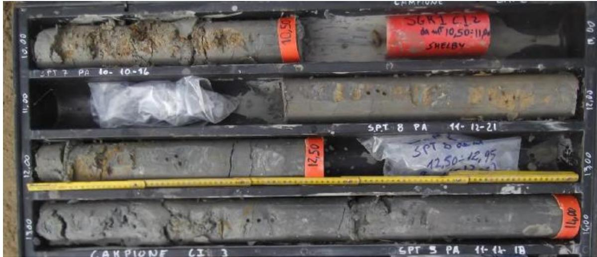
Fig. 2 – Livello geotecnico 2 (Formazione geologica dell' ANZ2ar) nel sondaggio SGR1
