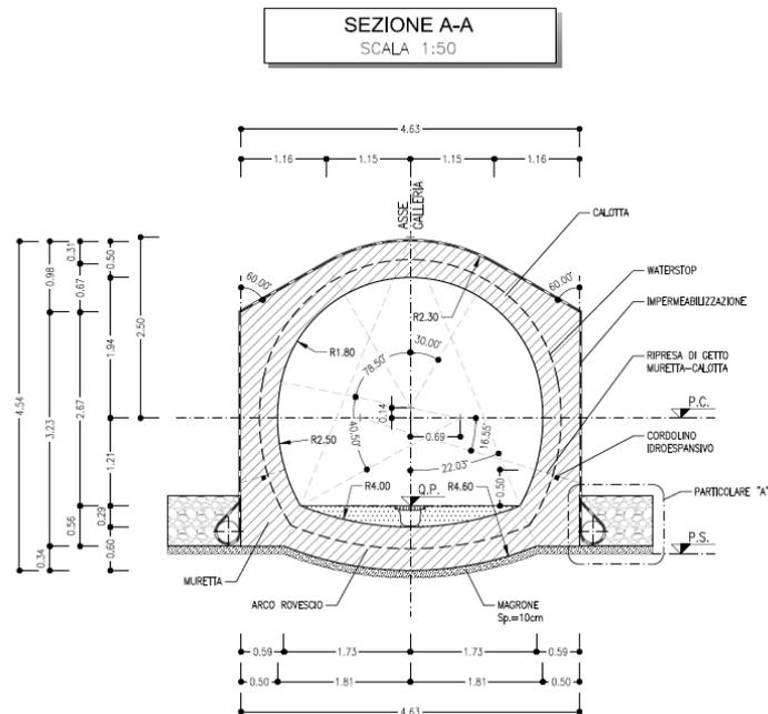
Figura 2 Sezione galleria artificiale
