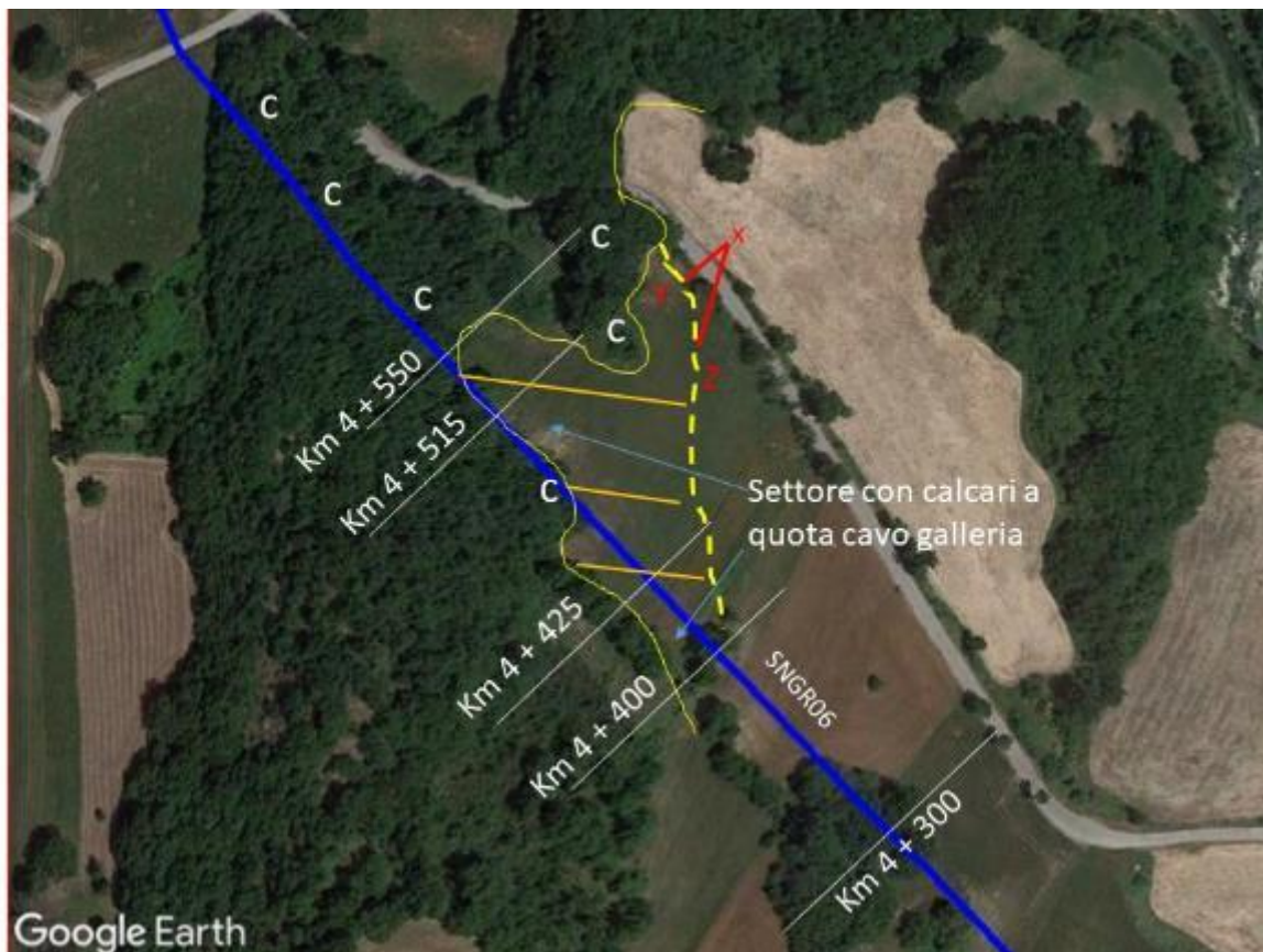
Figura 6-3 – Perforazioni teleguidate alla pk 4+515 della Galleria Grottaminarda
