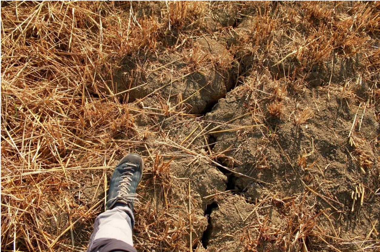
**Figura 30. Rotture nella cotica erbosa nel settore della nicchia di distacco della Frana di Grottaminarda**
