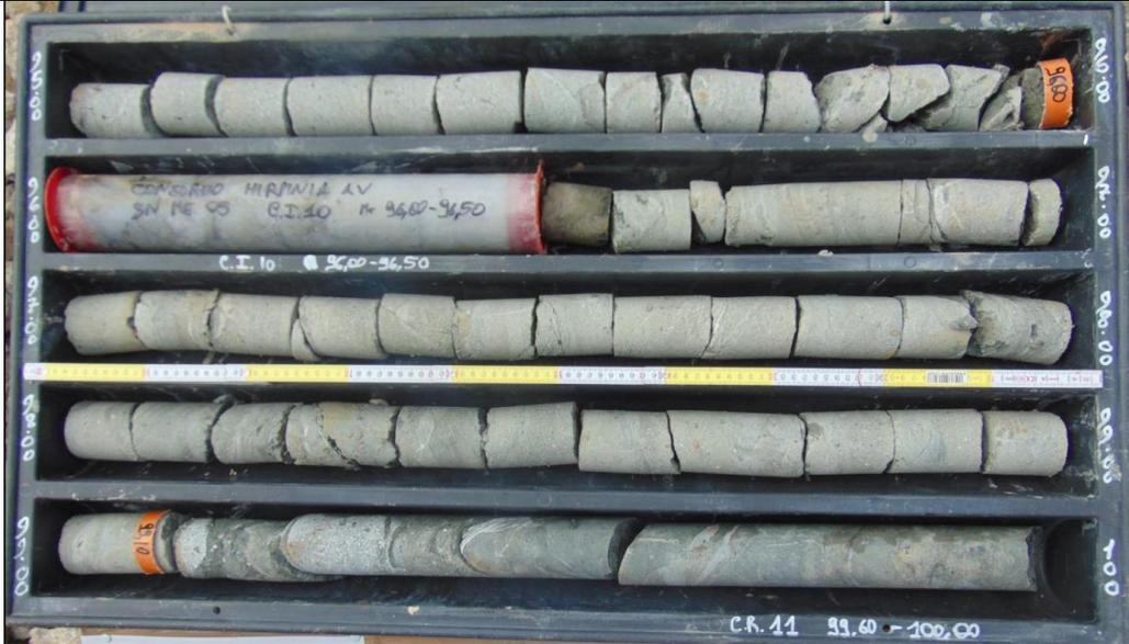
Figura 8. Spezzoni di carote di sondaggio (SN-ME-05) prevalentemente costituiti da arenarie e marne della formazione del Vallone di Ponticello (PCL).
