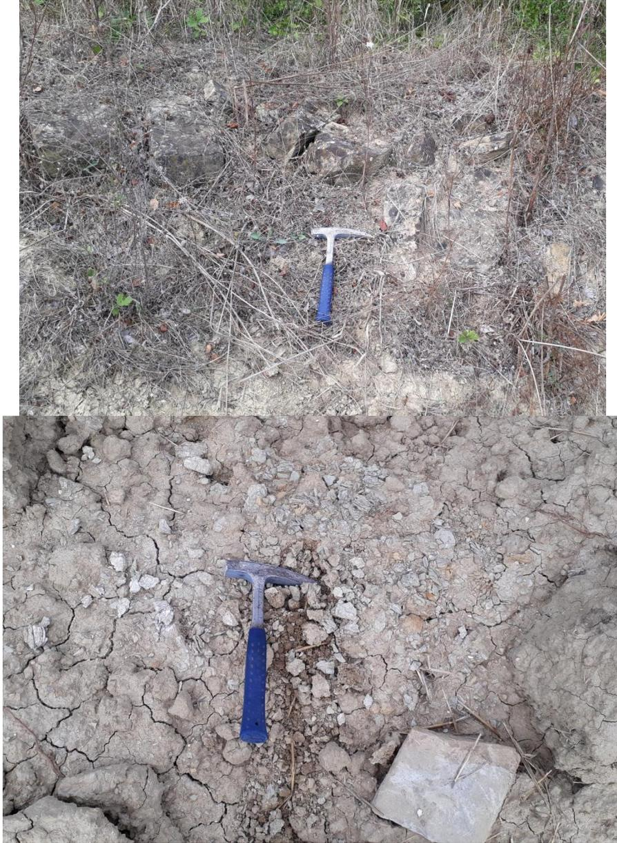
Figura 9. Subaffioramento della litofacies sabbioso – arenacea (ANZ2ar) nei pressi del versante a monte dell'imbocco lato Bari della Galleria Grottaminarda: in alto strati pluridecimetri di arenarie giallastre; in basso gli strati più marnosi grigiastri.
