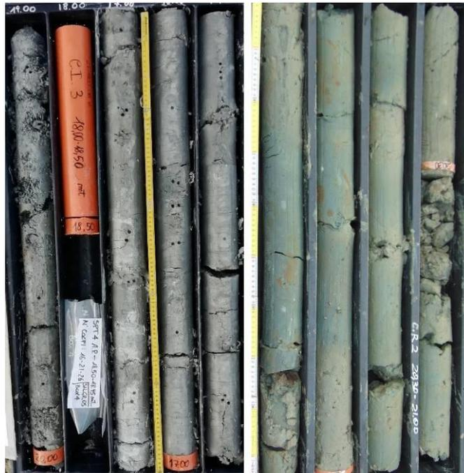
Figura 7. Spezzoni di carote di sondaggio (SN-GR-04 e SN-GR-05) prevalentemente costituiti da argille e argille marnose (FYR).
