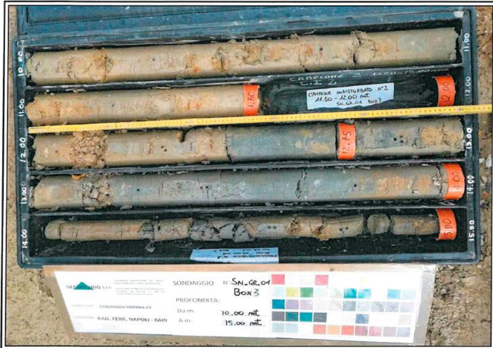
Figura 10. Aspetto in sondaggio delle alternanze sabbioso arenacee giallastre e pelitiche grigiastre della litofacies ANZ2ar; sondaggio SN-GR-01 della campagna indagini di PE, ubicato sul versante a monte dell’imbocco lato Bari della galleria Grottaminarda.
