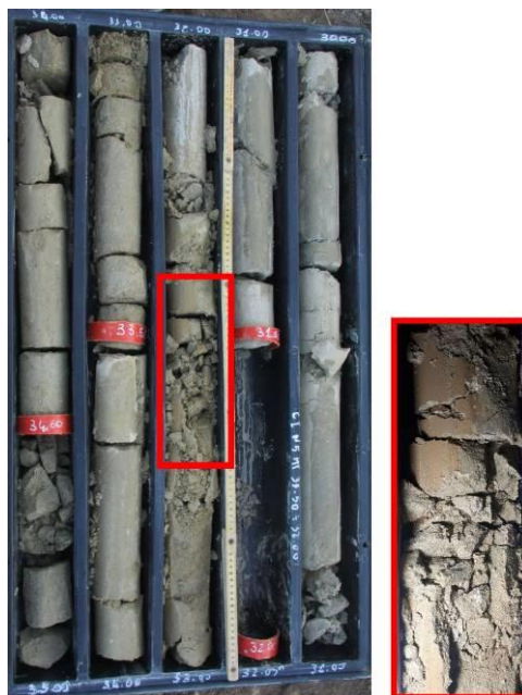
Figura 11. Dettaglio di un livello arenaceo appartenente alla litofacies sabbioso arenacea (ANZ2ar) campionato dal sondaggio SN-GR-06.
