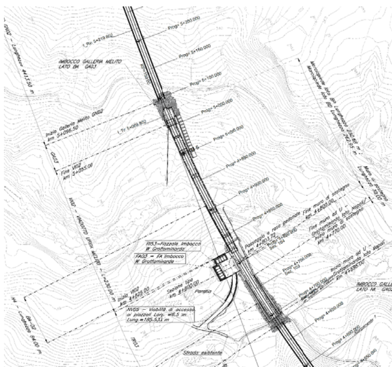
Figura 2-10. Planimetria della linea con imbocco lato Napoli galleria Grottamina, viadotto Melito e imbocco lato Bari galleria Melito
