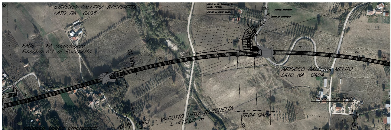
Figura 2-15. Planimetria della linea con imbocco lato Napoli galleria Melito, viadotto Rocchetta e imbocco lato Bari galleria Rocchetta
