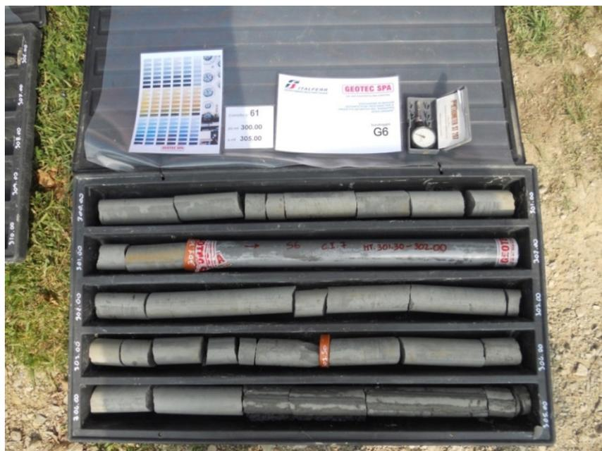
Le analisi granulometriche eseguite sui campioni prelevati dai fori di sondaggio mostrano la prevalenza dei termini limo-argillosi e subordinatamente sabbiosi; dal punto di vista granulometrico tale materiale è classificabile come limo con argilla debolmente sabbioso. Le analisi granulometriche sono state eseguite anche sui campioni con caratteristiche litoidi, previa destrutturazione del materiale in laboratorio.
