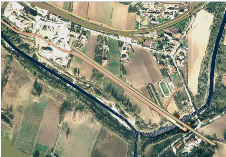
Figura 8-20. Viadotto VI04: Inserimento del modello BIM tridimensionale nel modello digitale del terreno e studio delle modalità di accesso alle aree di lavoro per la realizzazione delle opere di fondazione delle pile e delle spalle.
