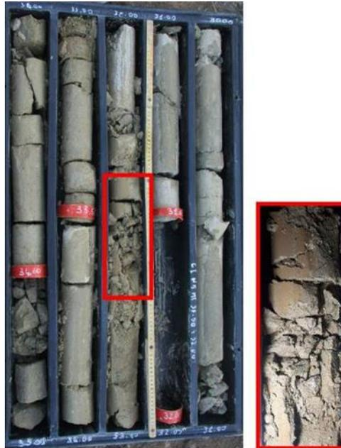
Figura 12. Dettaglio di un livello arenaceo appartenente alla litofacies sabbioso arenacea (ANZ2ar) campionato dal sondaggio SN-GR-06.
