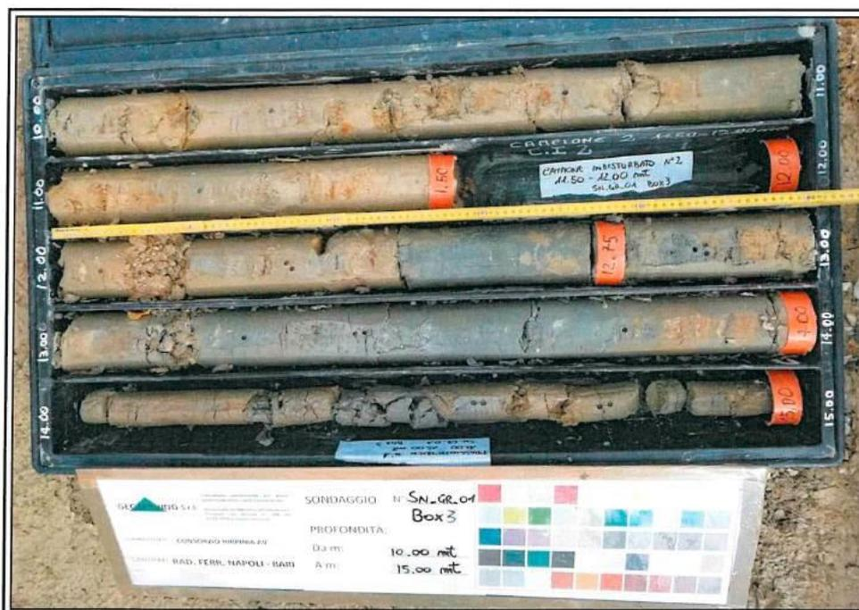
Figura 11. Aspetto in sondaggio delle alternanze sabbioso arenacee giallastre e pelitiche grigiastre della litofacies ANZ2ar; sondaggio SN-GR-01 della campagna indagini di PE, ubicato sul versante a monte dell'imbocco lato Bari della galleria Grottaminarda.
