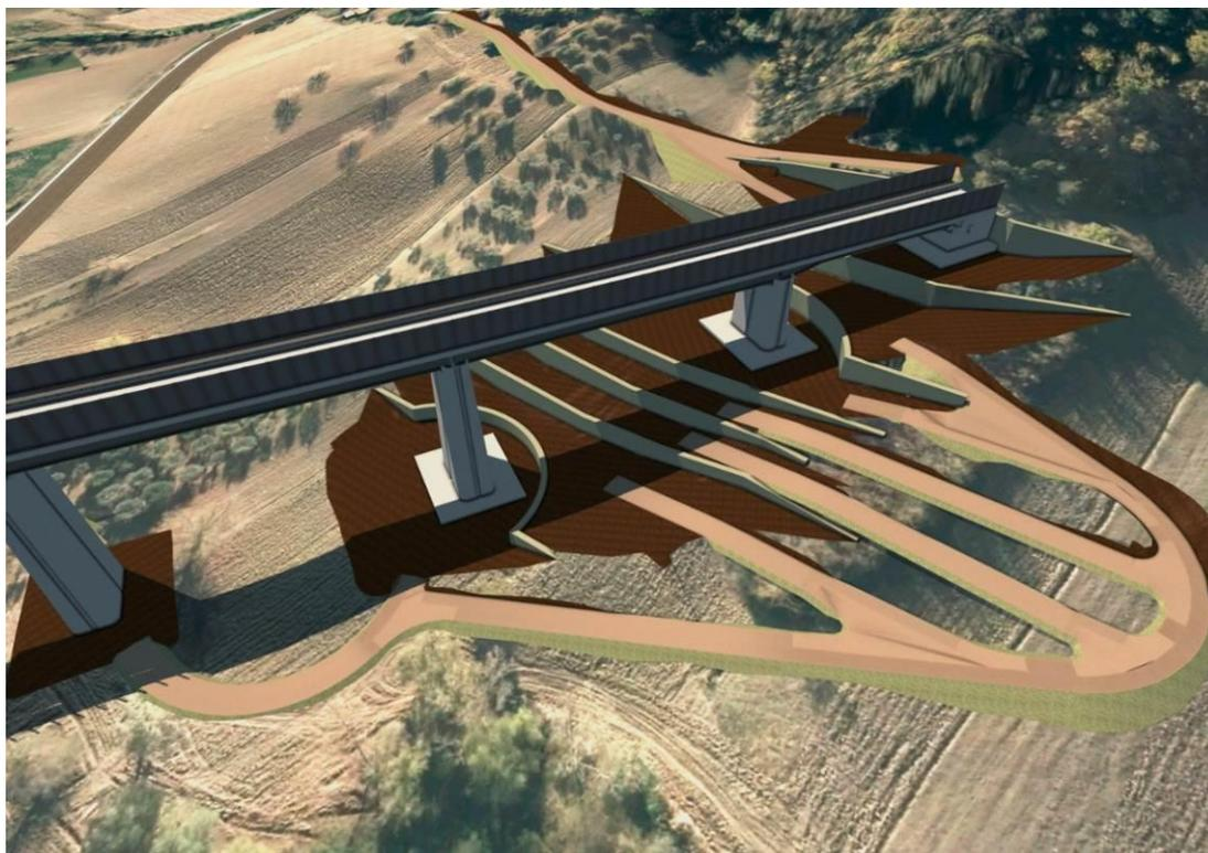
Figura 8-18. Viadotto VI03: Gradonatura del versante e opere di stabilizzazione versante Ovest – lato Galleria Rocchetta
