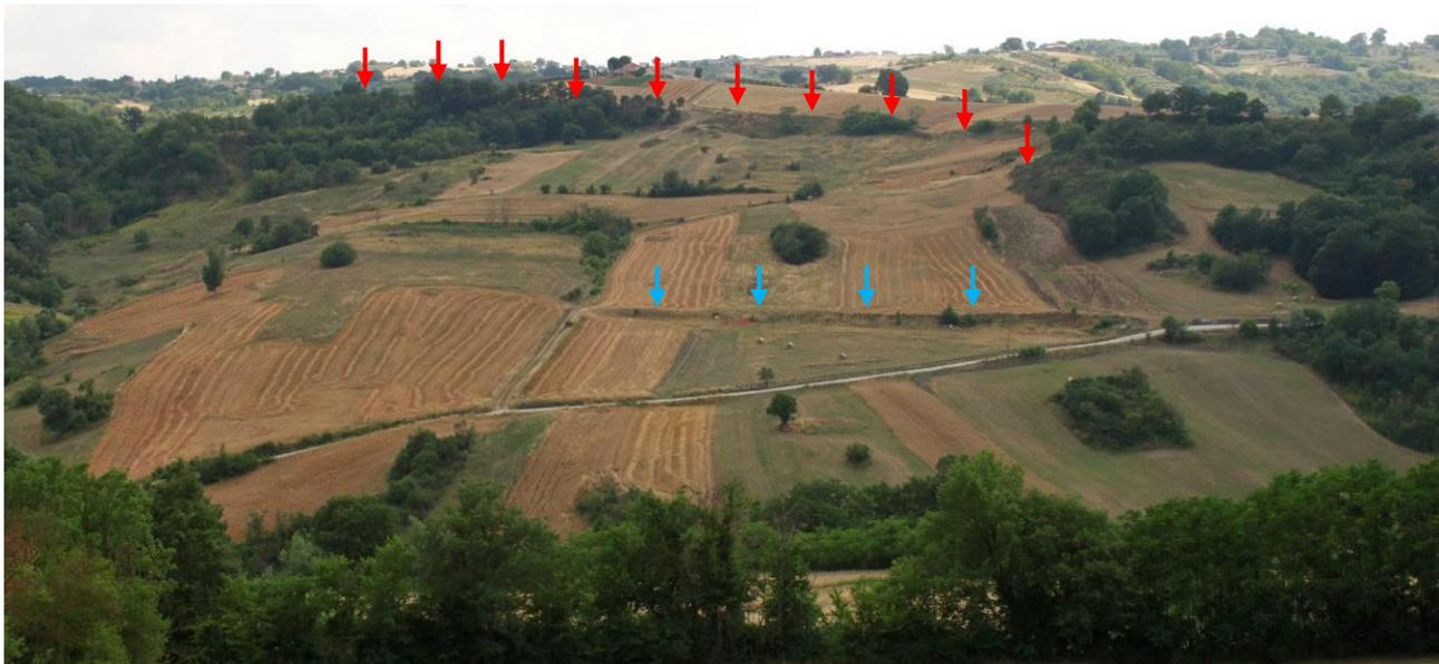
**Figura 29. Foto con vista frontale della frana di Grottaminarda. Le frecce rosse indicano la posizione della scarpata principale, le frecce blu quella di una scarpata interna al corpo di frana.**
