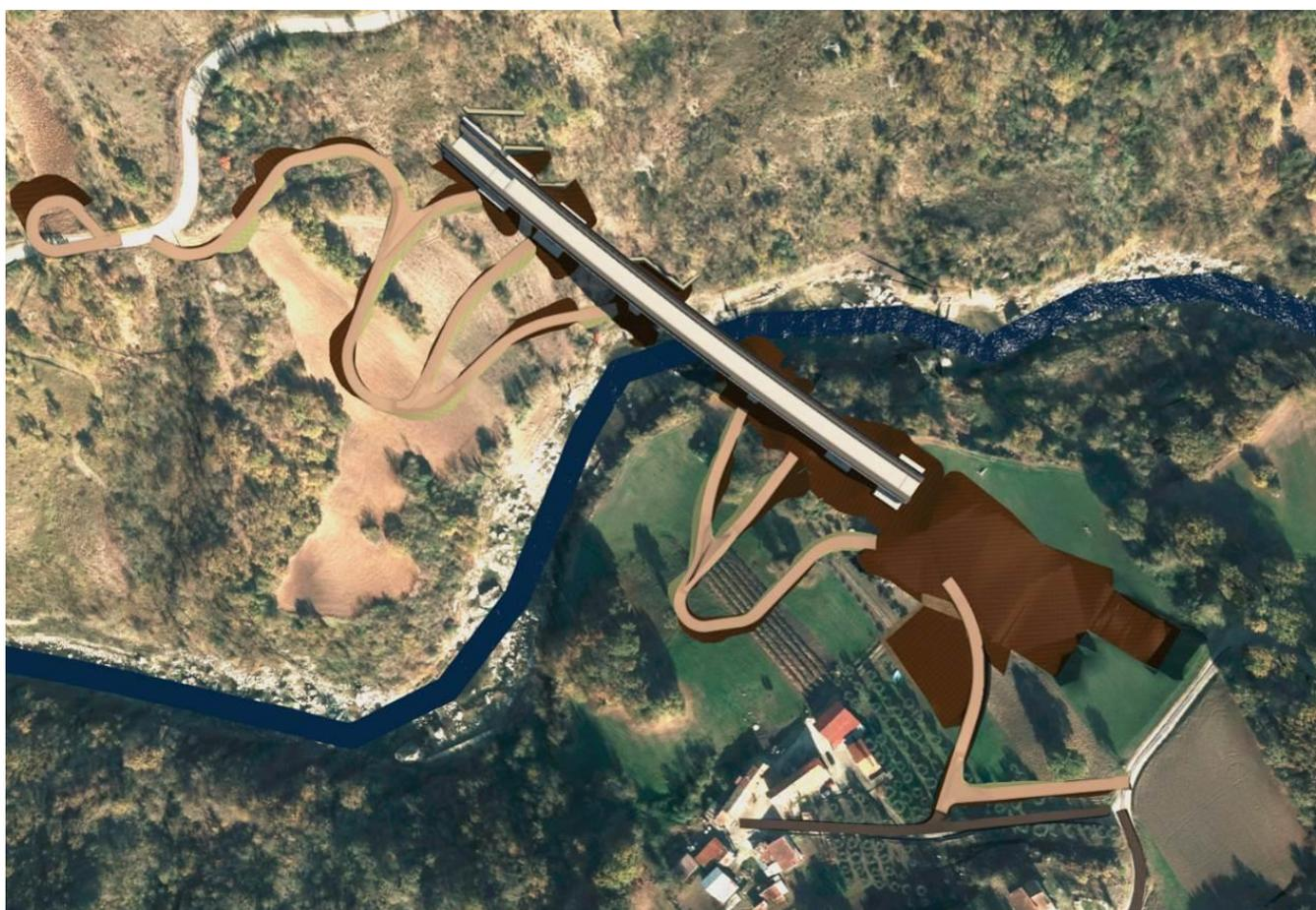
**Figura 8-11. Viadotto VI02: Inserimento del modello BIM tridimensionale nel modello digitale del terreno e studio delle modalità di accesso alle aree di lavoro per la realizzazione delle opere di fondazione delle pile e delle spalle. Sul versante Ovest è visibile l'impronta delle paratie OS1-OS4.**
