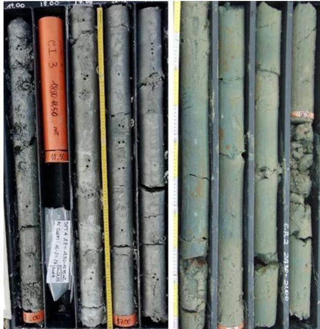
Figura 8. Spezzoni di carote di sondaggio (SN-GR-04 e SN-GR-05) prevalentemente costituiti da argille e argille marnose (FYR).
