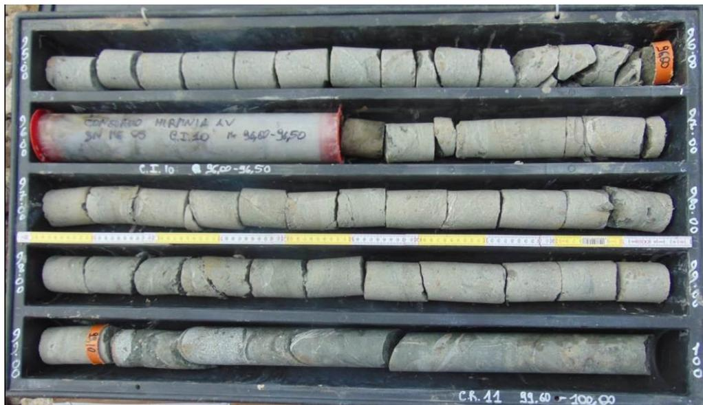
Figura 9. Spezzoni di carote di sondaggio (SN-ME-05) prevalentemente costituiti da arenarie e marne della formazione del Vallone di Ponticello (PCL).
