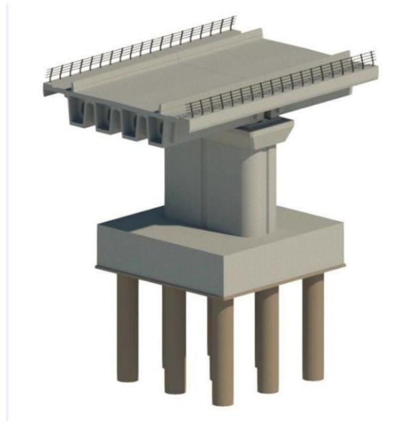
Figura 8-6. Sezione tipica viadotti impalcati viadotti realizzati con travi a csoncino in c.a.p.
