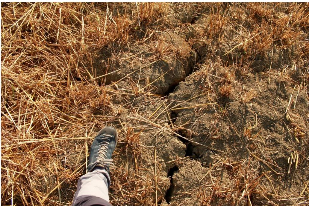
**Figura 31. Rotture nella cotica erbosa nel settore della nicchia di distacco della Frana di Grottaminarda**
