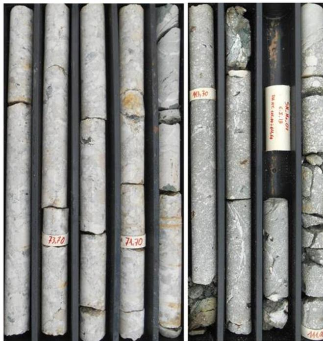
Figura 6. Spezzoni di carote di sondaggio con breccie calcaree poligeniche (sinistra) e calciruditi (destra) riferibili alla formazione FYR2 e campionate dal sondaggio SN-ME-07.
