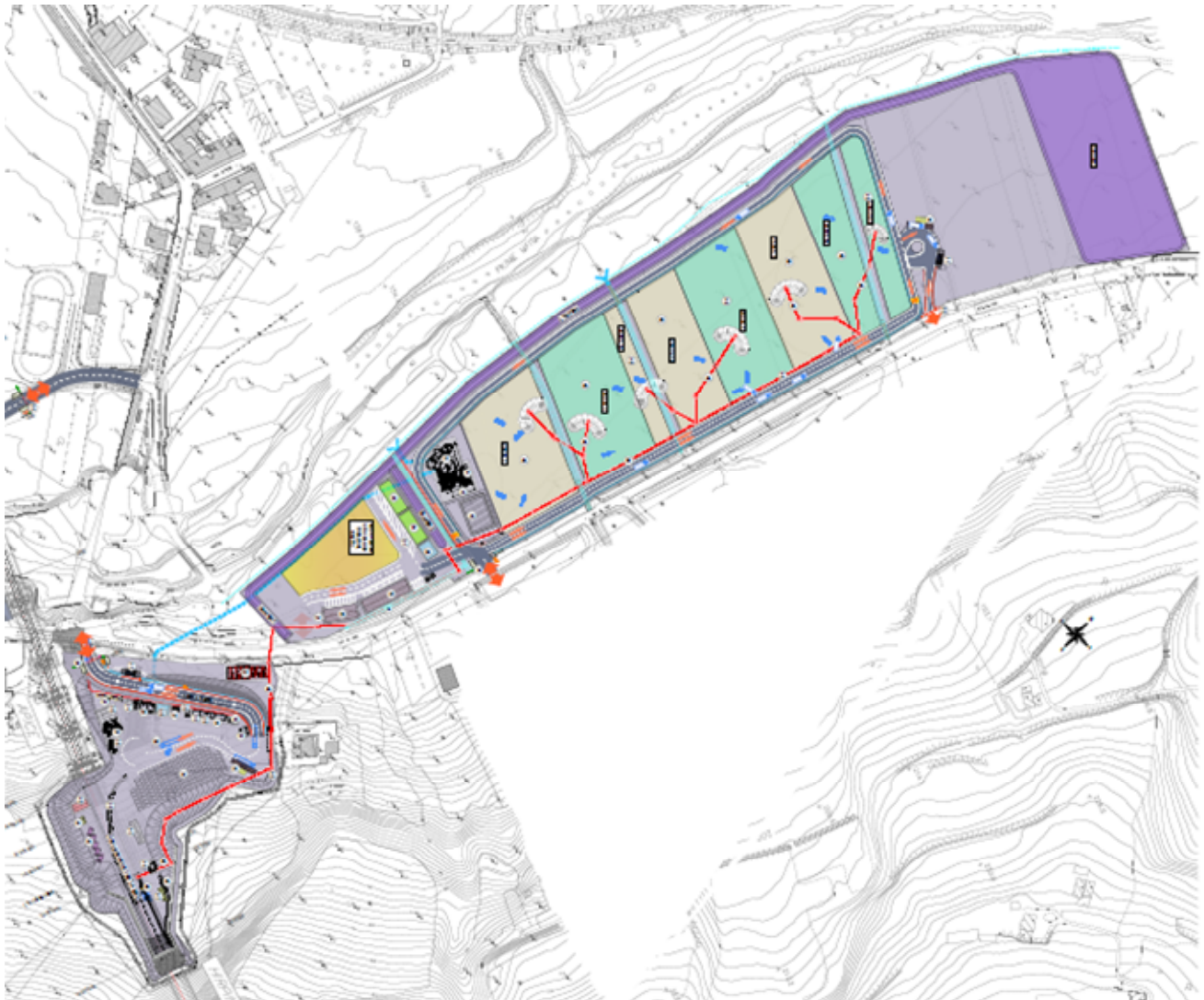
Figura 4-8. Area Rocchetta: lay-out cantiere CG-GN03.1 e aree di stoccaggio e tecniche a servizio dello scavo della galleria
