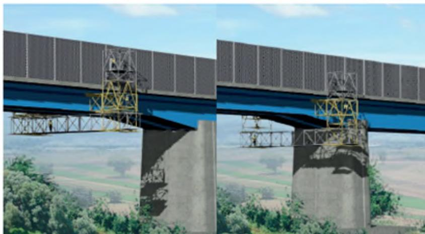
Figura 3.2. Schema funzionamento carrello nei tratti di impalcato ad altezza variabile
