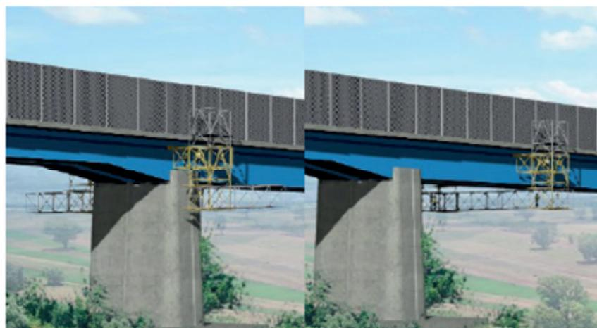
Figura 3.3. Schema funzionamento apertura/chiusura carrello in corrispondenza pile
