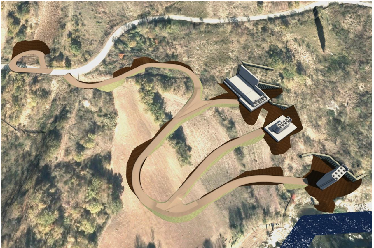
Figura 5.24. Fase realizzativa Me-4 creazione dei piani di lavoro da cui eseguire le opere di fondazione delle pile, della spalla e del manufatto di raccordo.
