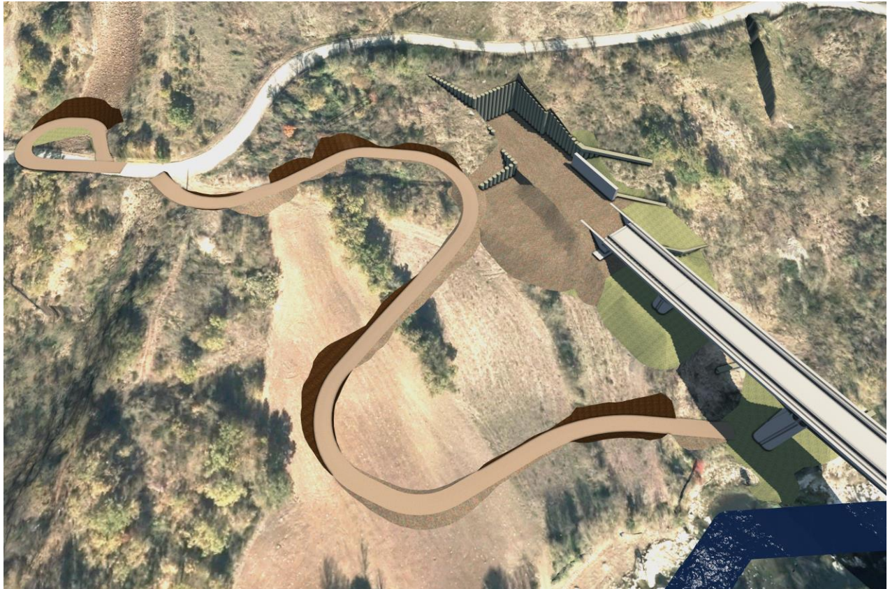
Fase Me-8 Figura 5.25. Ponte e piazzale di rimontaggio della TBM ultimati
