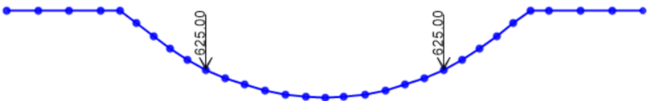
Figura 15 – Carico dovuto alla traslazione della TBM : 12500 KN/10m/2
