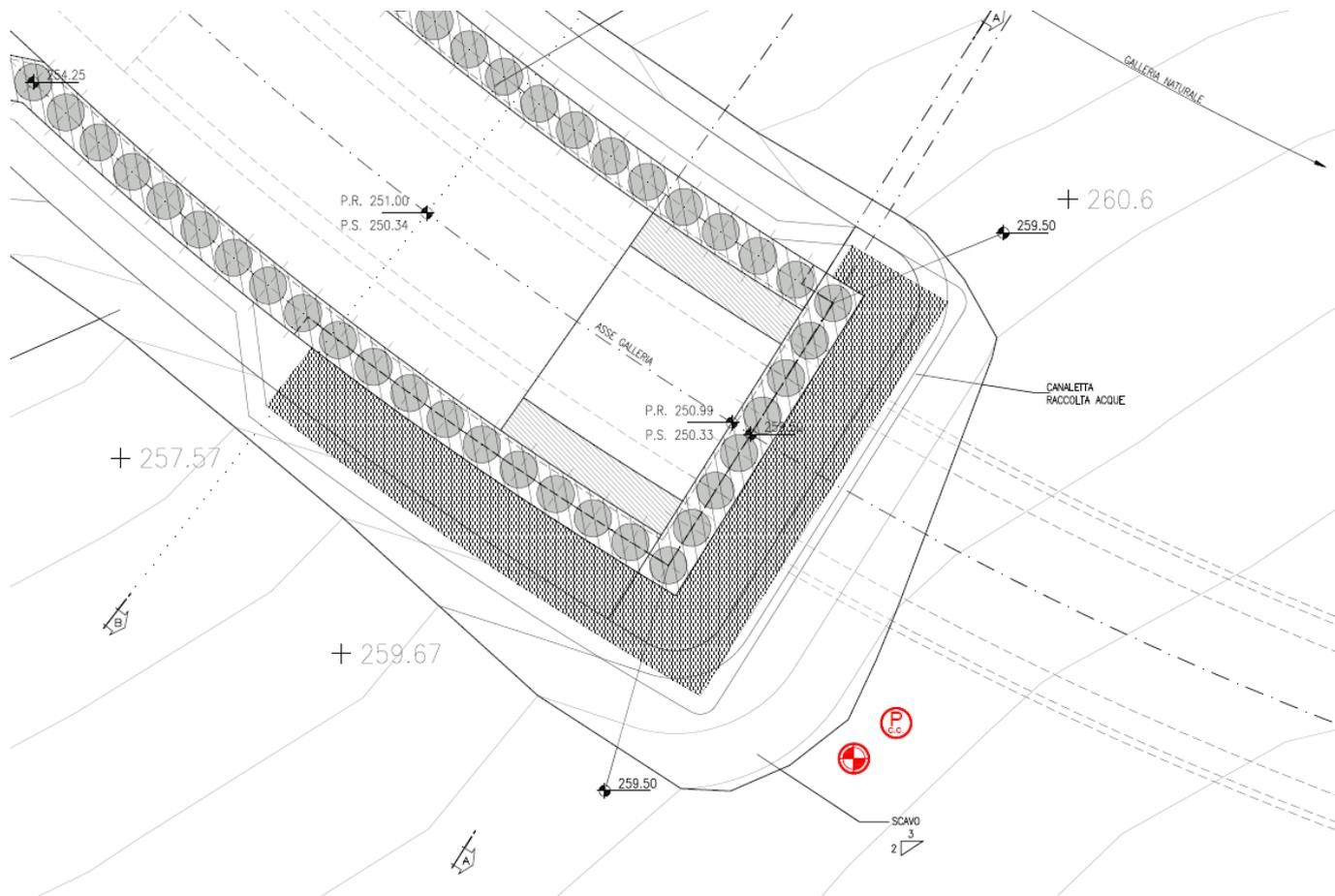
**Figura 3-1 – Posizionamento piezometro ed inclinometro (in rosso)**
