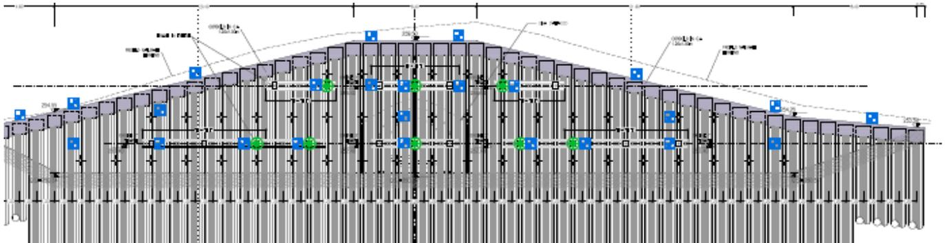
**Figura 3-2. Monitoraggio paratia: posizionamento delle mire ottiche (blu) e delle celle di carico toroidali (verdi)**
