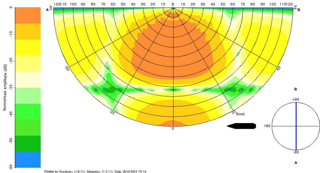
Figura 2.14 - Direzionalità dell’impulso acustico dell’ array di air-gun., misurata in senso ortogonale al moto della nave
