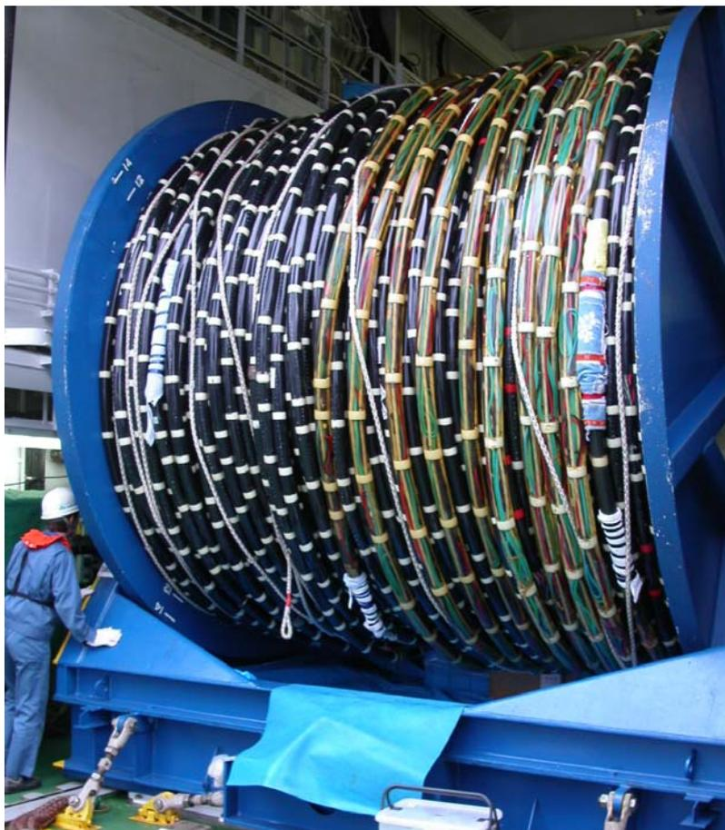
*Figura 2.6- Cavo per acquisizione sismica*
