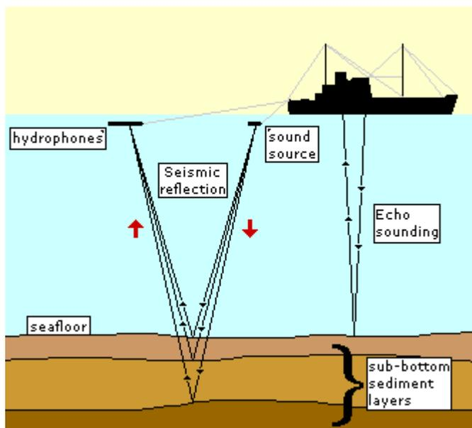
Figura 2.4 - Schema di prospezione geofisica con Air-gun
