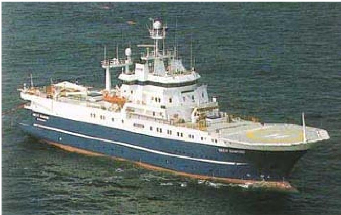
*Figura 2.5 - Nave per acquisizione sismica*
