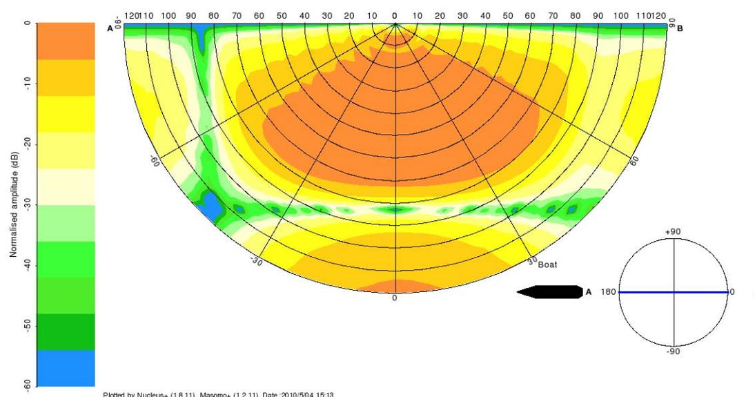
Figura 2.13 - Direzionalità dell'impulso acustico dell' array di air-gun.,
