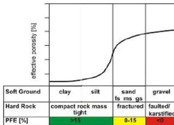
Figura 4 – Relazione fra la polarizzazione indotta (PFE) e la porosità efficace per una classificazione geologica.
