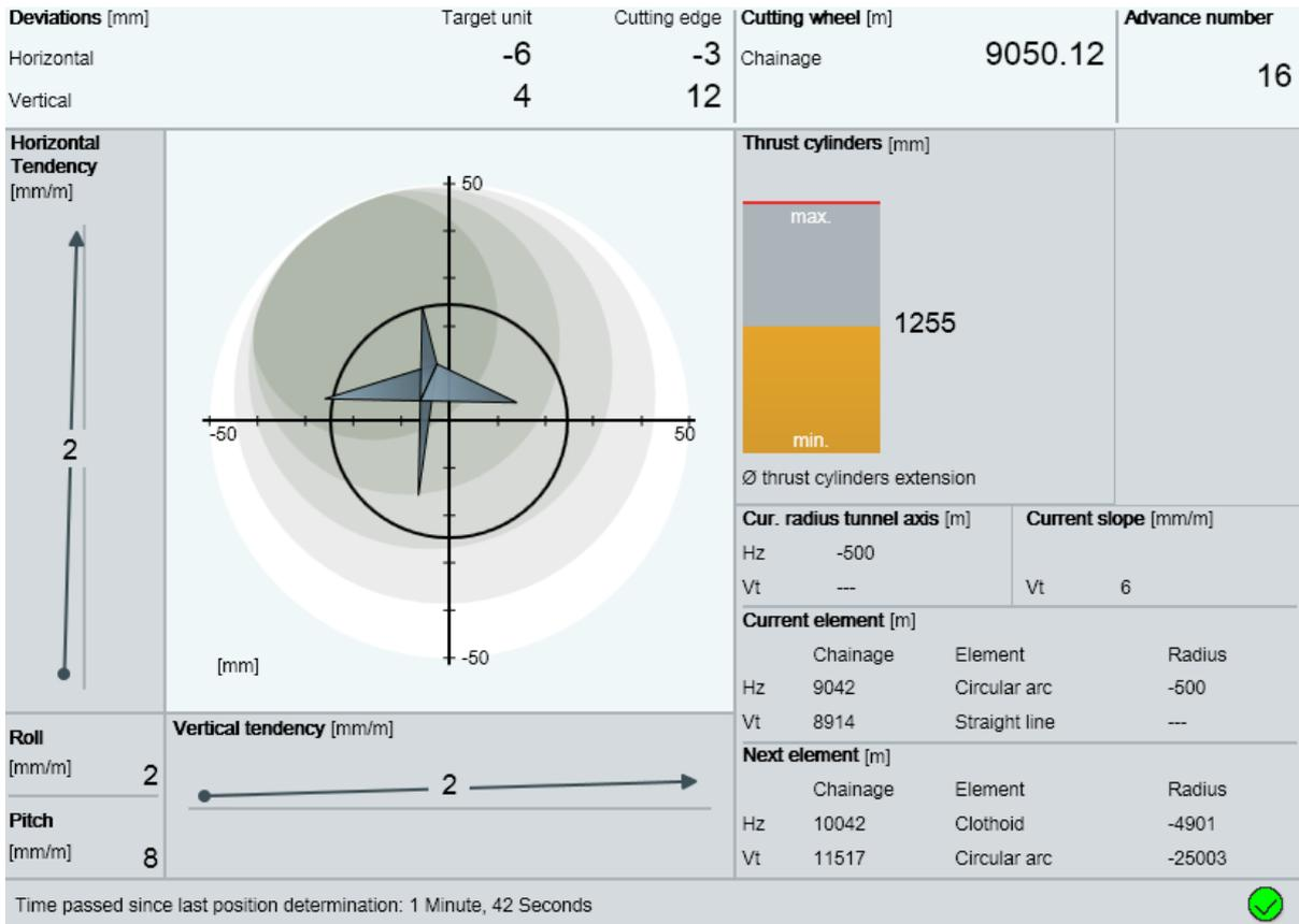
Figura 1 – Esempio di monitoraggio del sistema di guida
