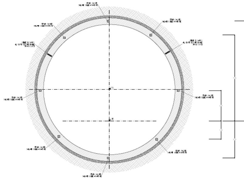
**Figura 3-2 – Esempio di stazione di misura dello stato tensionale**
