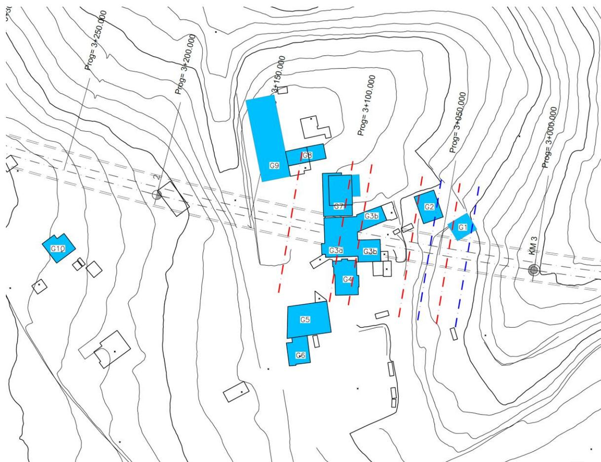
Figura 8-1 – Panimetria delle interferenze con galleria di linea , edifici interferenti (in azzurro) e sezioni di misura (in rosso e blu)
