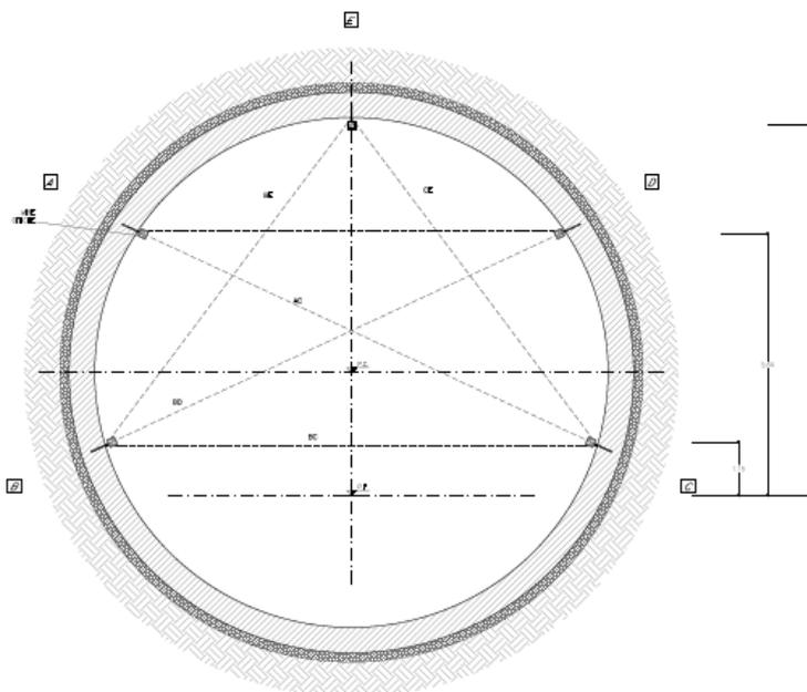
Figura 3-1 – Esempio di stazione di misura della convergenza
