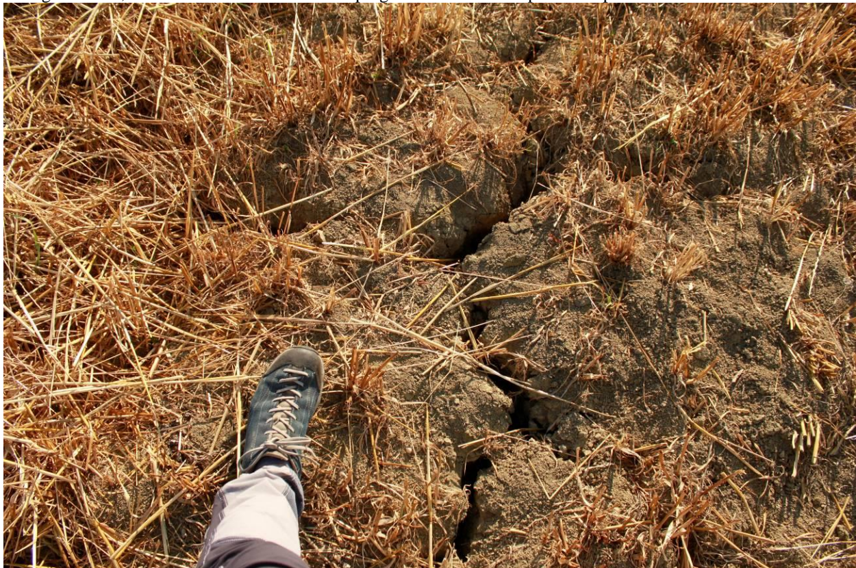
Figura 4. Rotture nella cotica erbosa nel settore della nicchia di distacco della Frana di Grottaminarda
