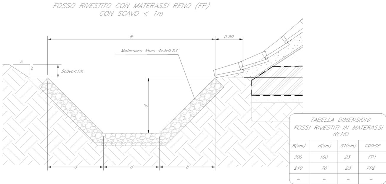
**Figura 3.2: Sezione tipologica di una sistemazione idrografica esistente.**
