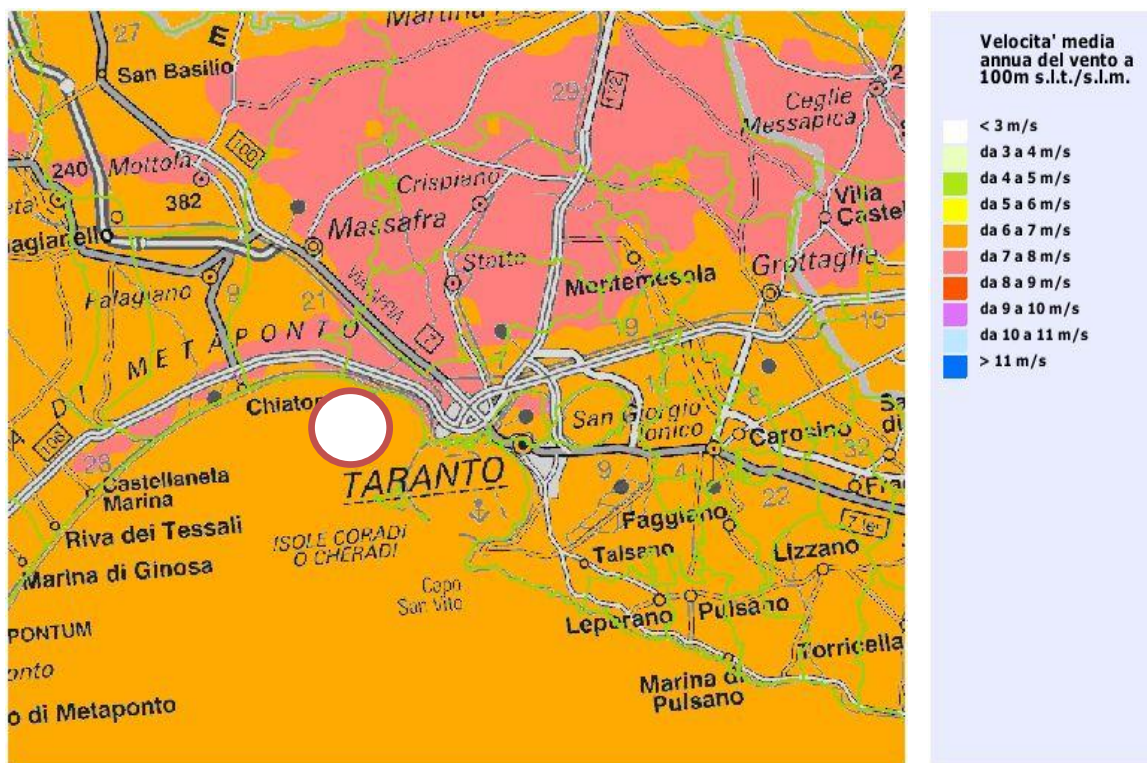
Figura 29 : Velocità media annua del vento a 100 m s.l.t./s.l.m. In bianco è segnalata l'area in cui sarà localizzato il parco eolico offshore. Fonte: http://atlanteeolico.cesiricerca.it
