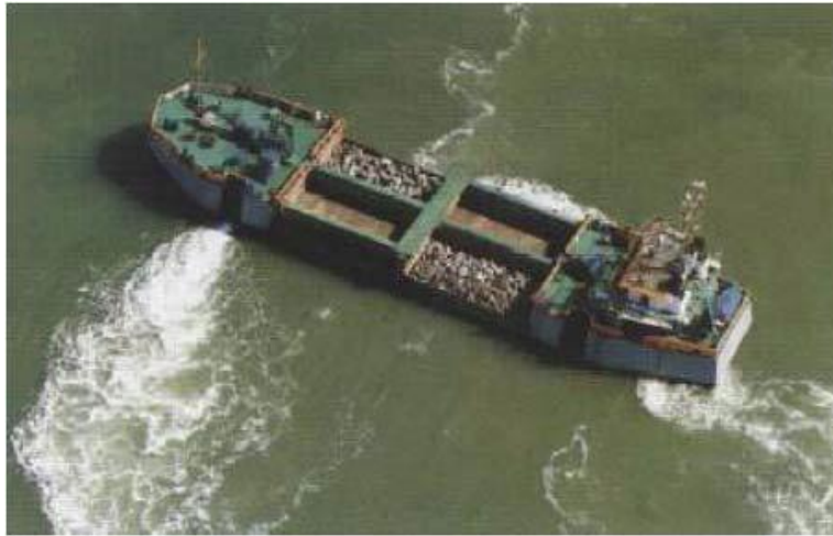
Figura 11: Imbarcazione utilizzata per la posa in mare del materiale ghiaioso e pietrisco.
