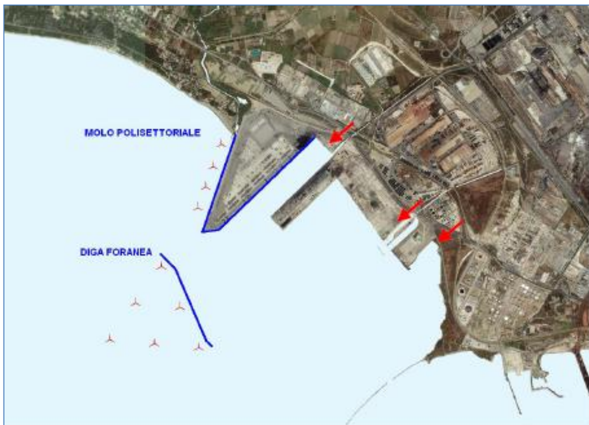
Figura 46: Individ. barriere fisiche (Diga foranea e Molo Polisetoriale) e degli scarichi industriali presenti
