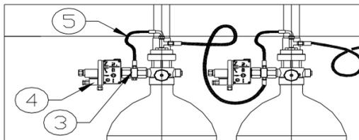
Figura 2 – Dettaglio Valvola di scarica e collettore pneumatico
