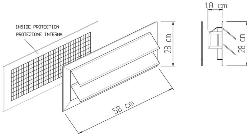
Figura 3 – Tipica di serranda di sovrappressione
