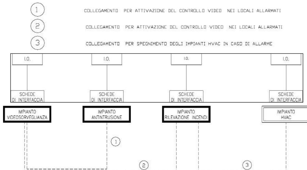
Per il collegamento con l'eventuale sistema di supervisione la centrale antintrusione dovrà dunque essere dotata di apposita interfaccia e linguaggio di comunicazione basato su protocolli standard non proprietari (es. Bacnet o Mod Bus RTU Ethernet).
